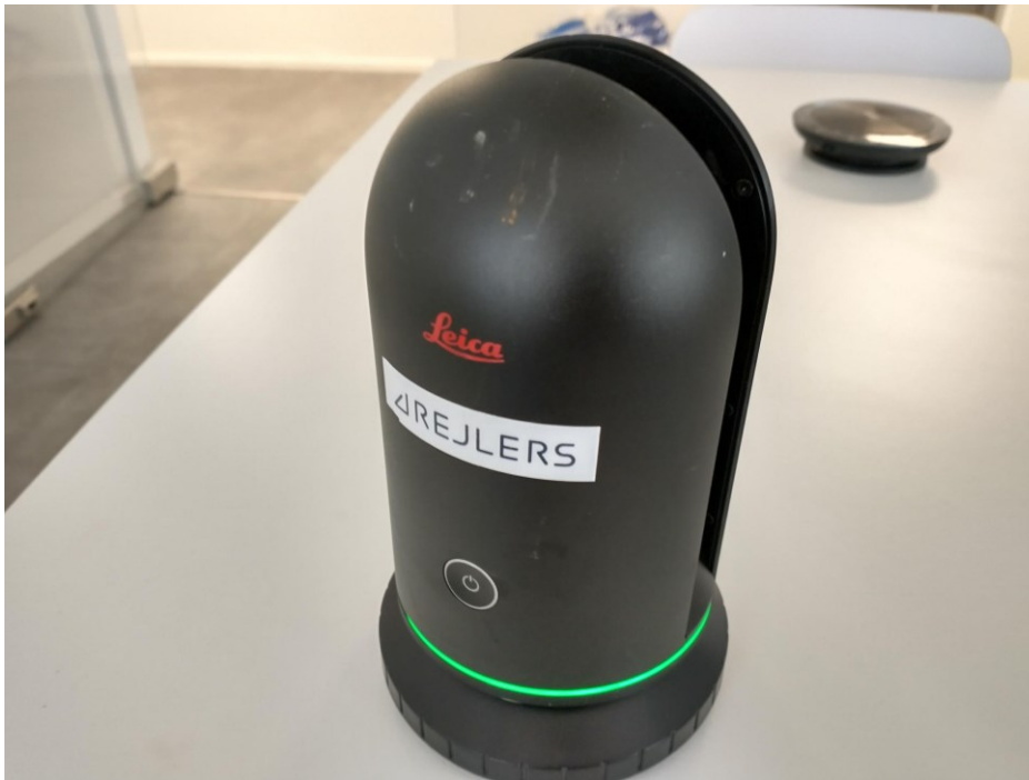
Kuva 4. BLK360-keilain jalustalla. Vihreä merkkivalo kertoo, että keilain on käyttövalmis.
