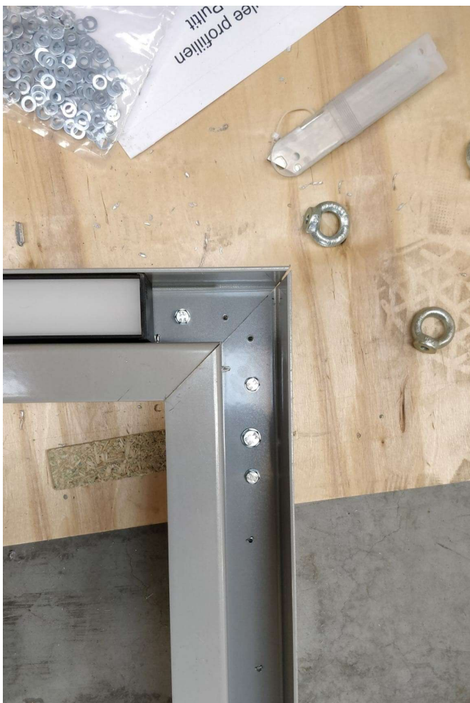
KUVA 2. Mallikappaleen alumiiniprofilien liitos
