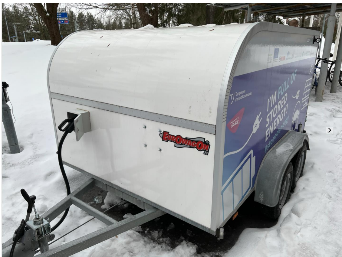
KUVA 3. Perävaunu, joka pitää sisällään 100 kWh:n litium-rautafosfaattiakuston.
