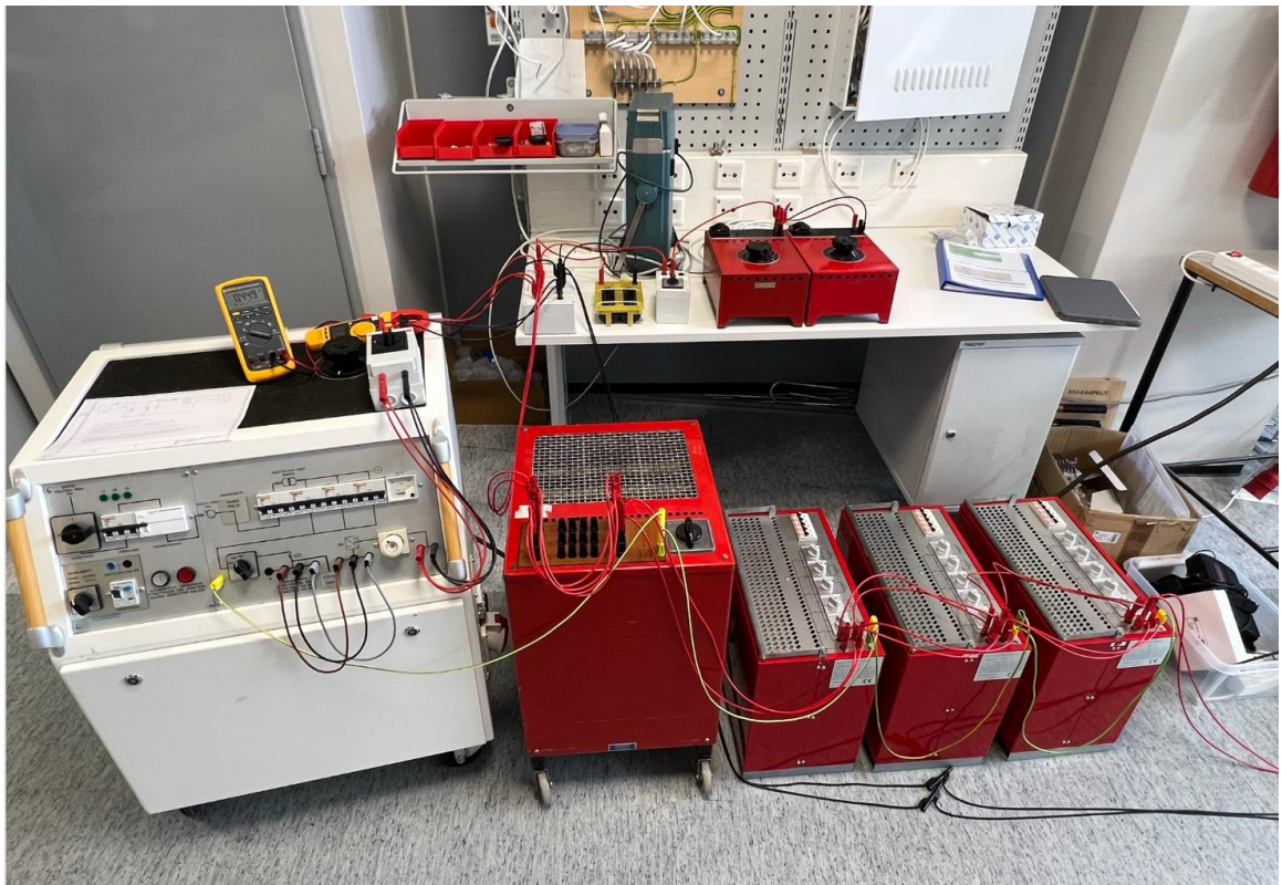
KUVA 13. Toisen mittauksen mittauskalustoa (vasemmalla virtavaunu, alhaalla vastuslaitteistot sekä ylhäällä kondensaattori ja purkuvastukset).
