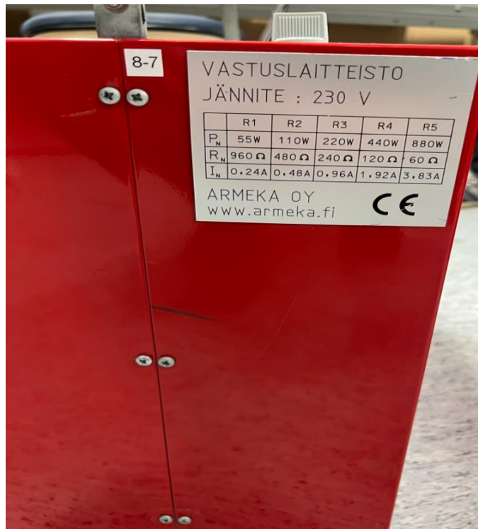
KUVA 10. Säättämätön vastuslaitteisto, 1,705 kW.
