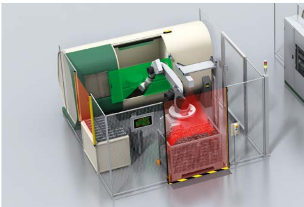
Kuva 3. Joustava automaattinen valmistusyksikkö (Automated CNC milling and turning machines).
