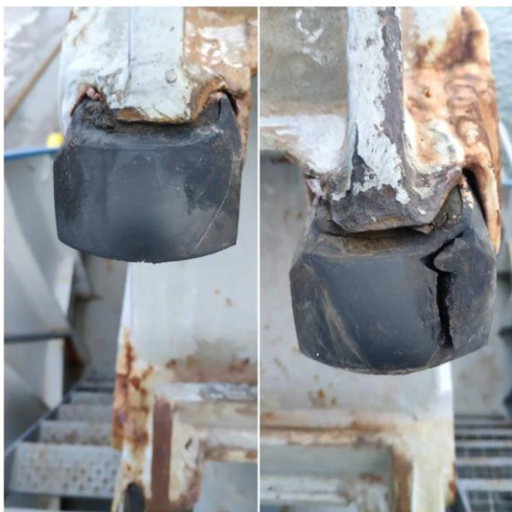
Bild 5 Jämförelse mellan en ny och sprucken tätningslist.
