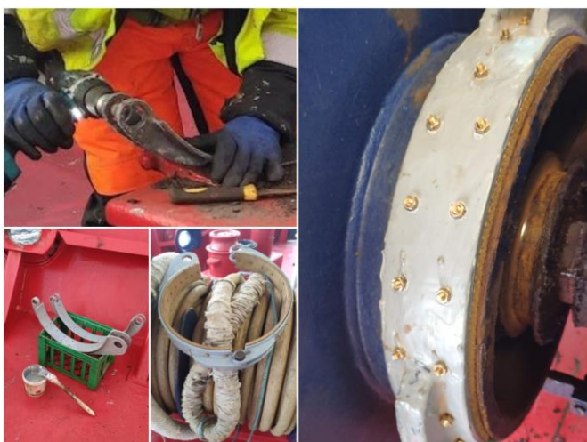
Bild 8 Bildserie av olika arbetskedan i broms byte.
