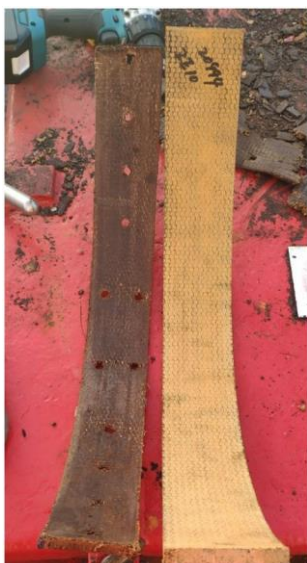
Bild 7 Jämförelse av ett gammalt och nytt bromsbelägg
