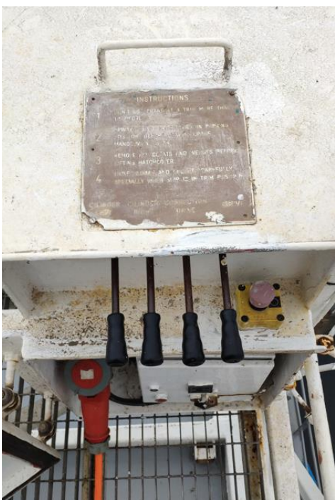
Bild 12 Kontrollspakar till kranen som man kör luckorna med.
