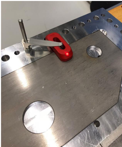
Kuva 10. Kiinnitysraudan paikoitus lasersäteellä (Kuva: Jarno Ronkainen)
