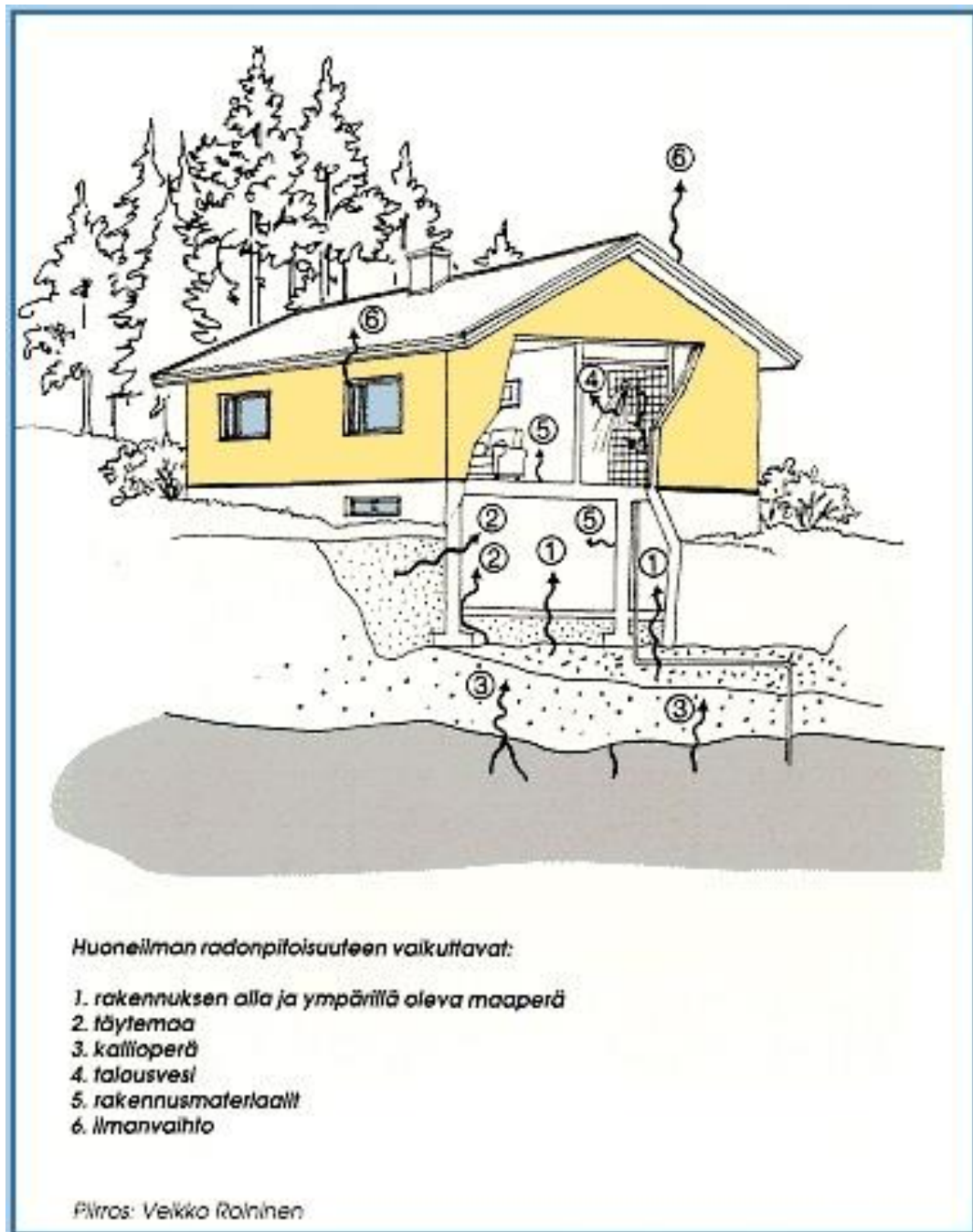
Kuva 2: Havainnekuva radonin lähteistä ja kulkeutumisesta rakennuksessa. (Lähde: https://www.stuk.fi/aiheet/radon/radonin-lahteet )
