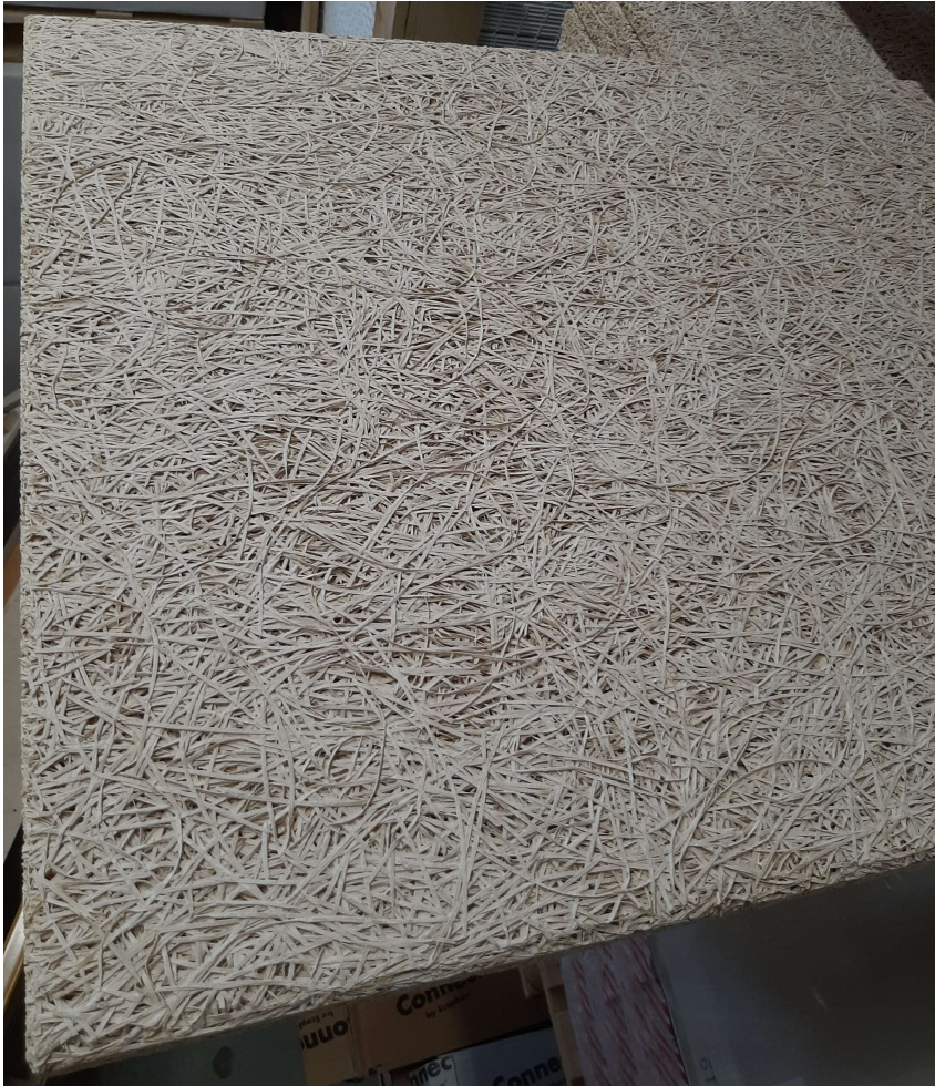
KUVA 5. Parafon Paracem 25x600x600mm
