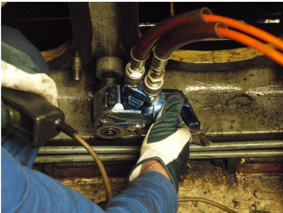
Kuva 23. Raamilaakerien sivupulttien hydraulinen avain (kuva Liisa-Maija Palviainen)
