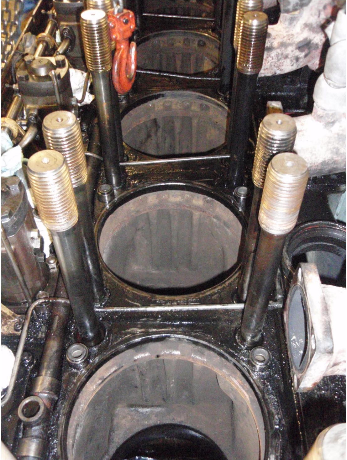
Kuva 19. Lohko ilman sylinteriputkia (kuva Liisa-Maija Palviainen)
