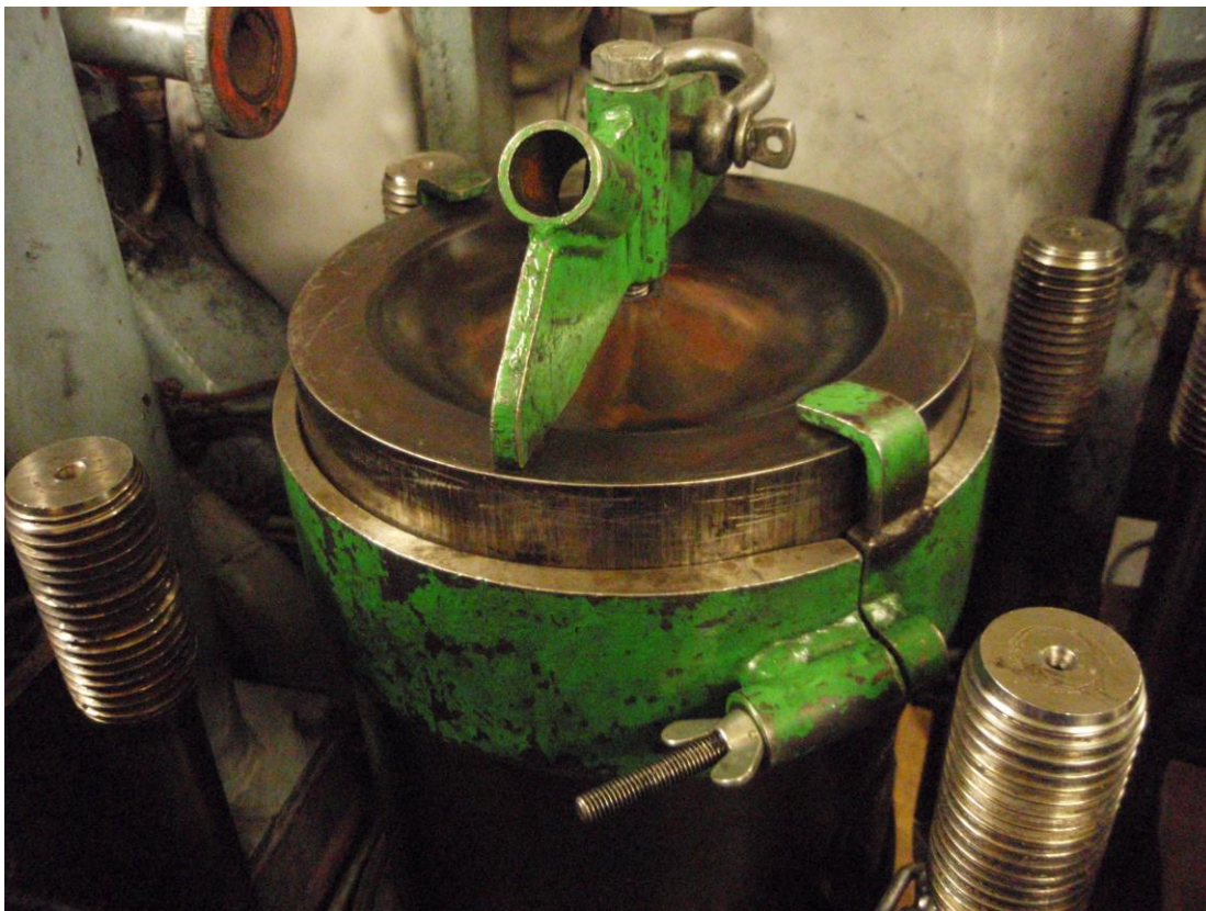
Kuva 30. Männänrenkaiden kiristyspanta (kuva Liisa-Maija Palviainen)
