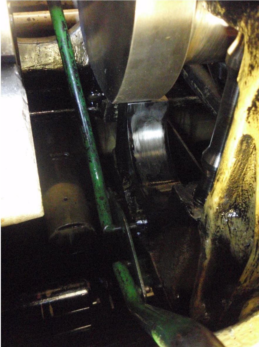
Kuva 25. Raamilaakerin pesän alaosa irrotettuna (kuva Liisa-Maija Palviainen)
