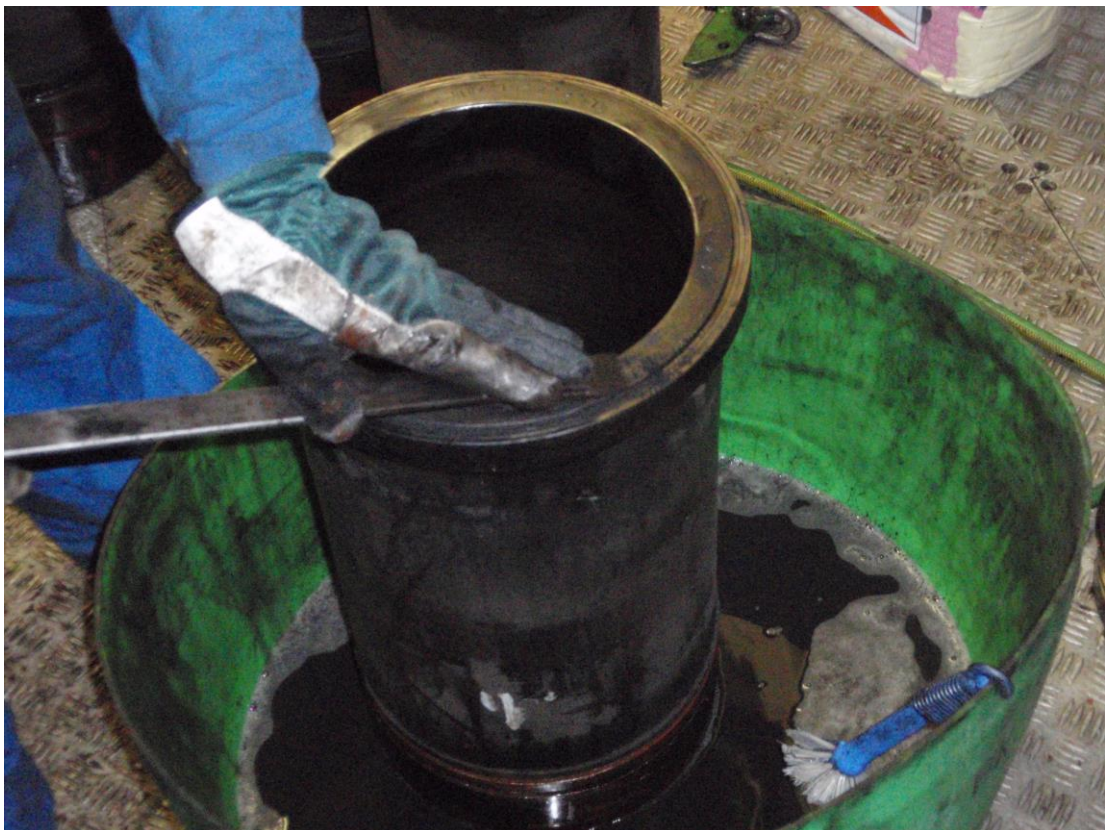
Kuva 21. Sylinteriputken yläpinnan puhdistus kaapimella (kuva Liisa-Maija Palviainen)
