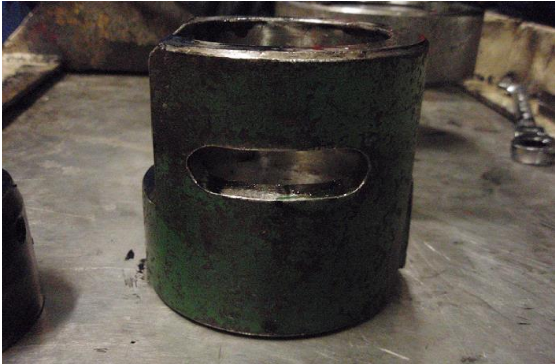
Kuva 4. Hydraulisen tunkin holkki (Kuva: Liisa-Maija Palviainen)
