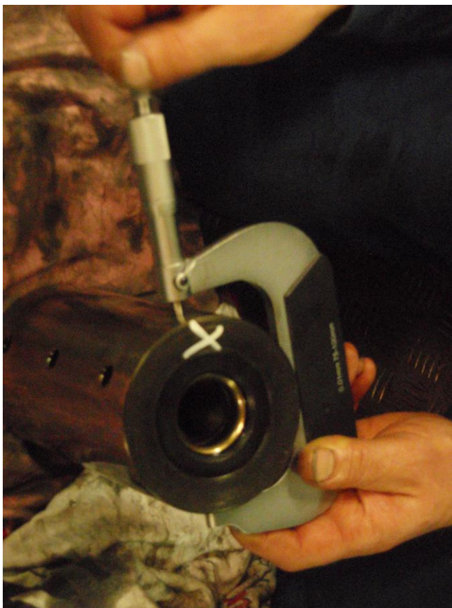
Kuva 16. Männäntapin mittaus (kuva Liisa-Maija Palviainen)
