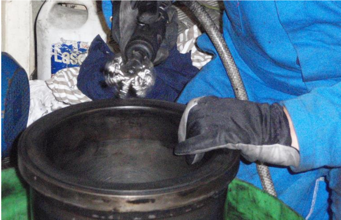
Kuva 20. Sylinteriputken yläpinnan puhdistus teräsharjalaikalla (kuva Liisa-Maija Palviainen)
