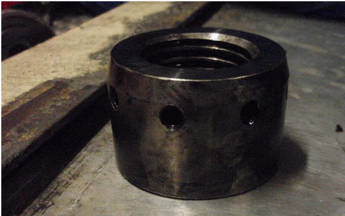
Kuva 5. Sylinterinkannen mutteri (Kuva: Liisa-Maija Palviainen)
