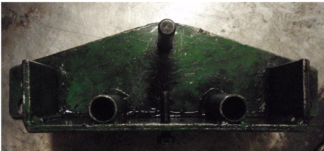
Kuva 24. Raamilaakerin irrotus- ja asennustyökalu (kuva Liisa-Maija Palviainen)
