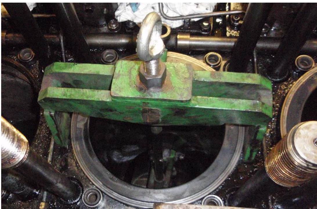
Kuva 17. Sylinteriputken ulosvedin (kuva Liisa-Maija Palviainen)
