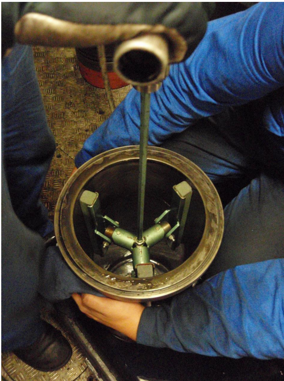
Kuva 22. Sylinteriputken hoonaus (kuva Liisa-Maija Palviainen)
