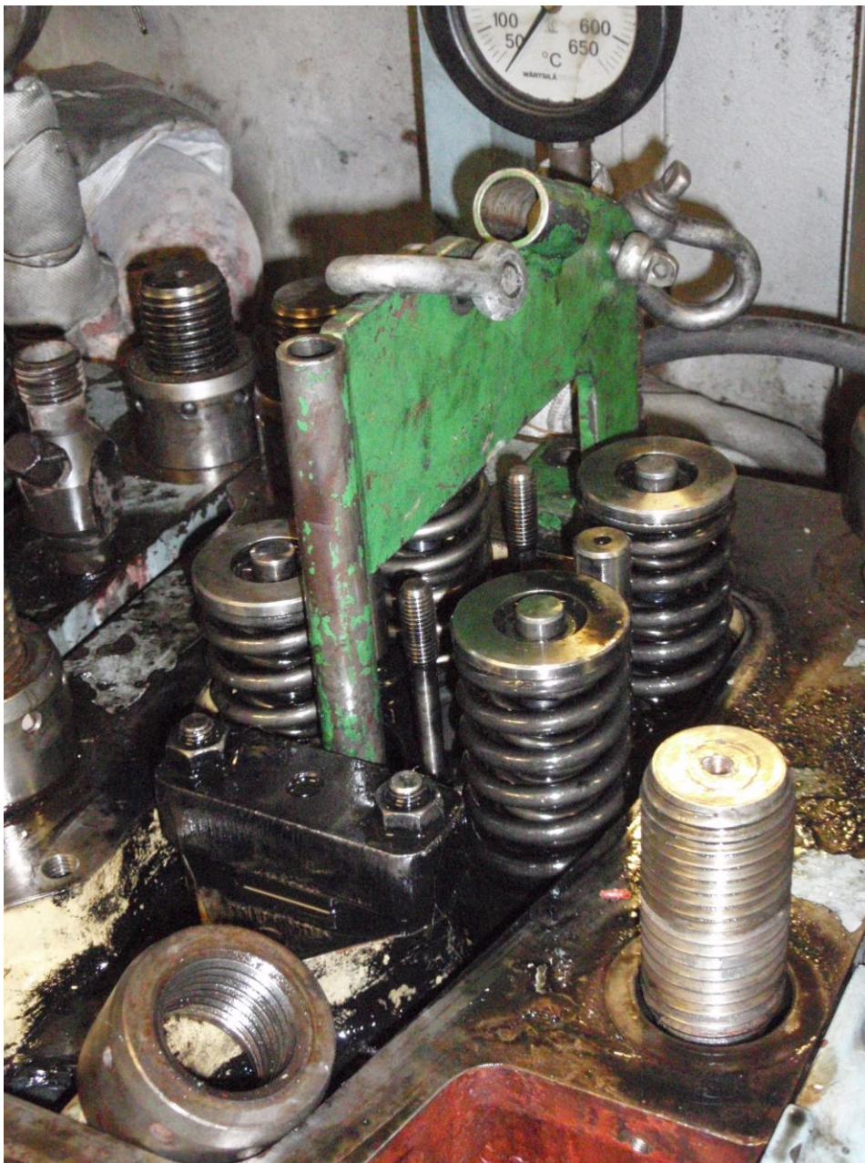
Kuva 6. Sylinterinkannen nostotyökalu (Kuva: Liisa-Maija Palviainen)
