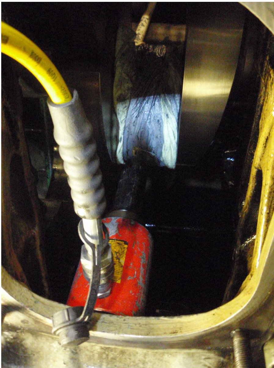
Kuva 26. Lohkon levitys tunkilla (kuva Liisa-Maija Palviainen)
