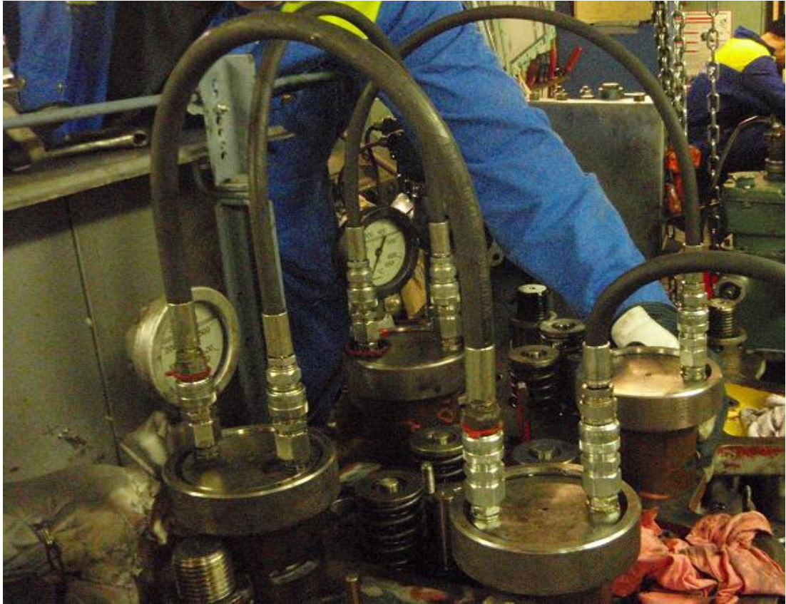
Kuva 3. Hydrauliset tunkit holkkeineen (Kuva: Liisa-Maija Palviainen)
