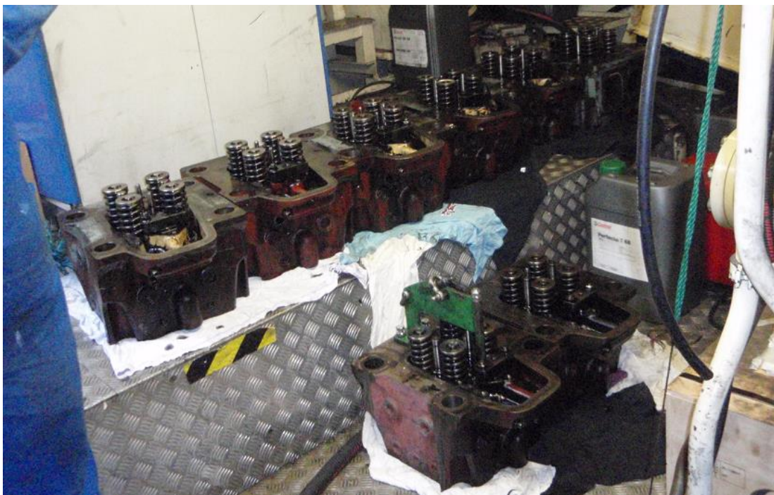
Kuva 8. Sylinterinkannet nostettuina (kuva Liisa-Maija Palviainen)
