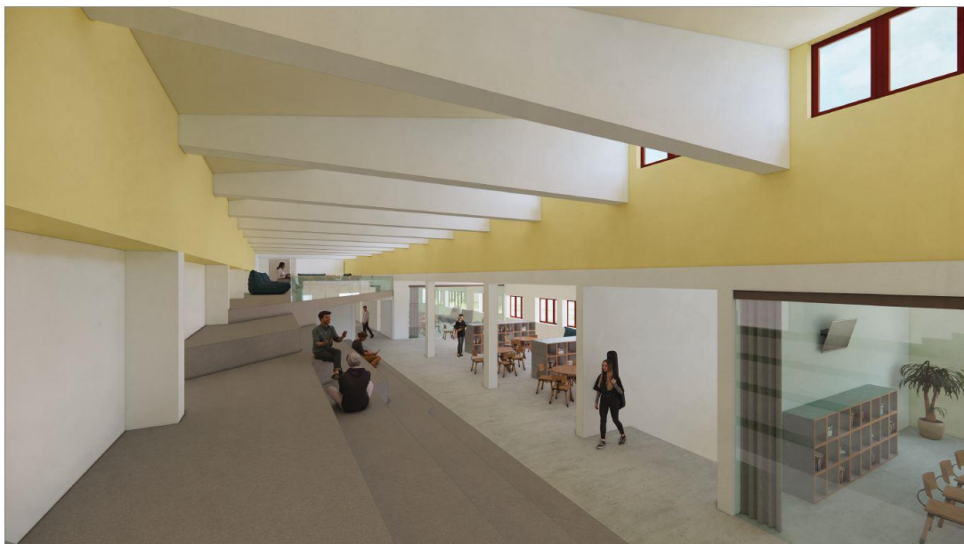
Kuva 21. Sisätiloissa keskilaivan katonharjan ikkunoista saapuva valo luo arvokasta ja rakennuksen massaa kuvastavaa tilallisuutta. Istuskeluportaat ikkunoiden alapuolella toimivat oleskelu- ja työskentelytilana. Palkkien päällä olevat seinät rapataan ja maalataan vastaamaan ulkoseinän pintaa.
