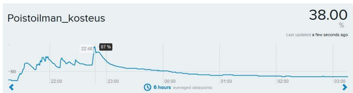
Kuva 20. Poistoilman kosteus ilmanvaihdon ollessa normaaliasennossa (Xively)
