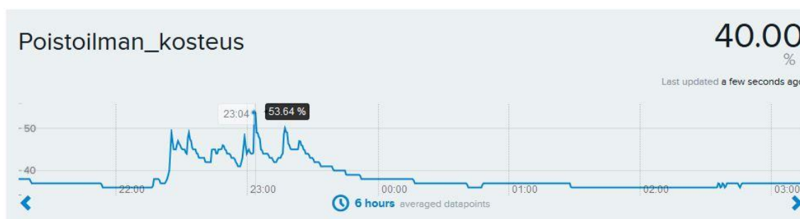
Kuva 21. Poistoilman kosteus ilmanvaihdon ollessa tehostettuna (Xively)
