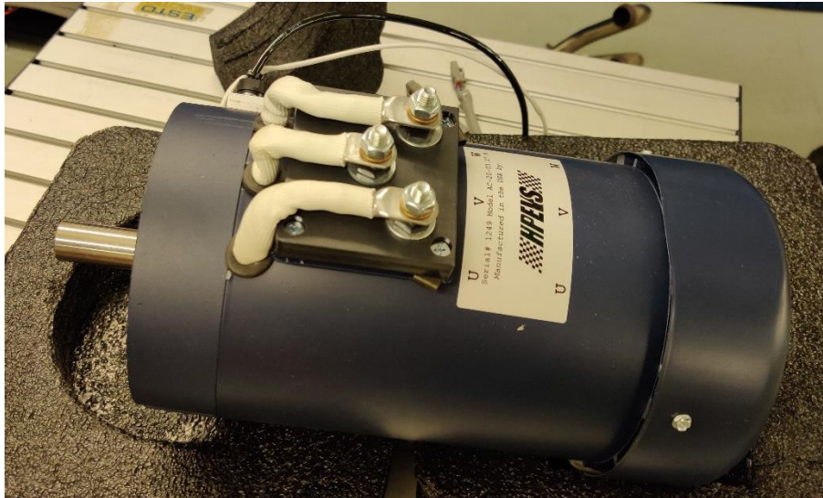
Kuva 20. HPEVS AC-20 oikosulkumoottori
