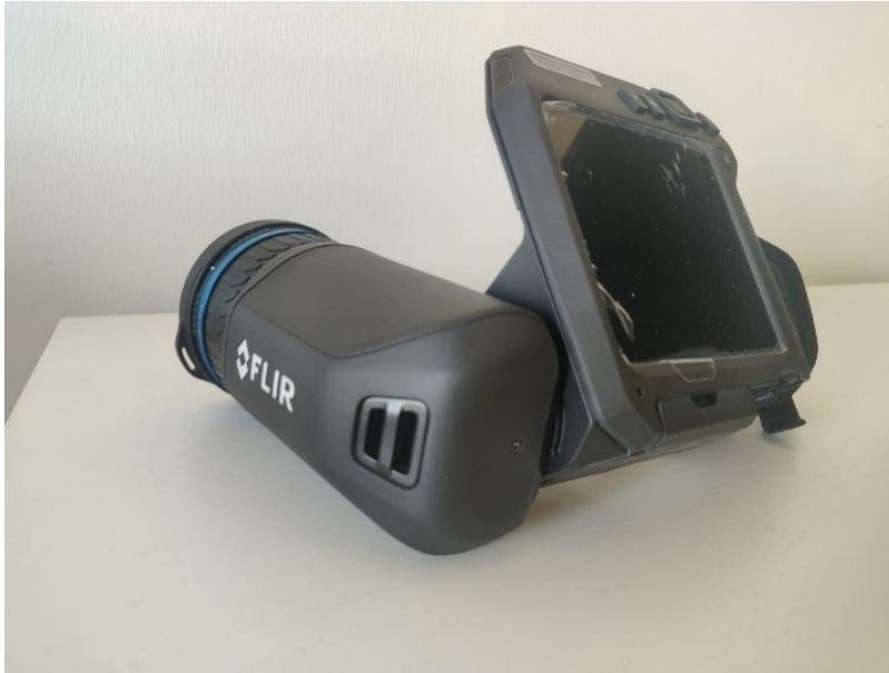
Kuva 7. Kuntoarviossa käytössä ollut lämpökamera FLIR t530.
