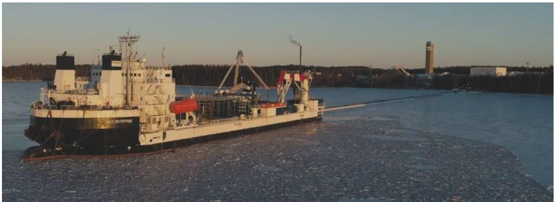
Kuva 2. Merikaapelin lastaus käynnissä (Prysmian Group Finland Oy 2022d)
