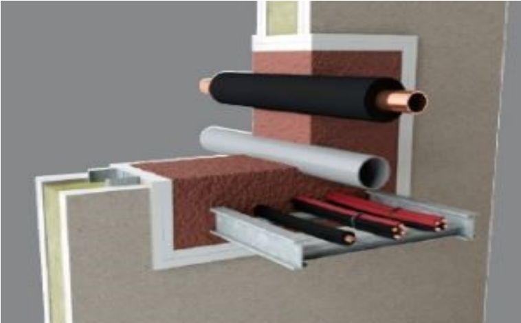
Kuvio 4. Yhdistelmäläpiviennin palokatko toteutettuna 2-komponenttisella palokatkoavaahdolla (Suomen Palokatko yhdistys, 2019, s. 21).
