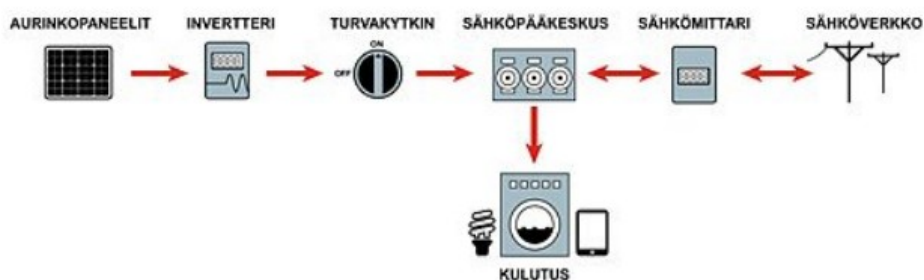
Kuva 1. Sähköverkkoon kytketty aurinkosähköjärjestelmä. (Motiva 2022).
