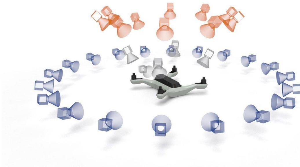
Kuva 5. Fotogrammetrian avulla skannaaminen selvennettyinä valokuvalla [6]
