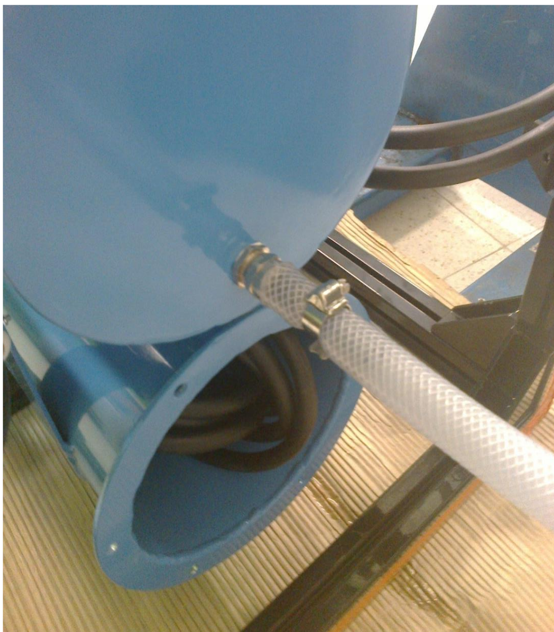
Kuva 28. Ylemmän painerungon tiiviiden testaus
