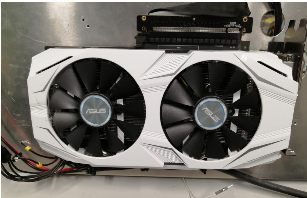
Kuva 9. Levyn alapuolelle on kiinnitetty tietokoneen näytönohjainyksikkö
