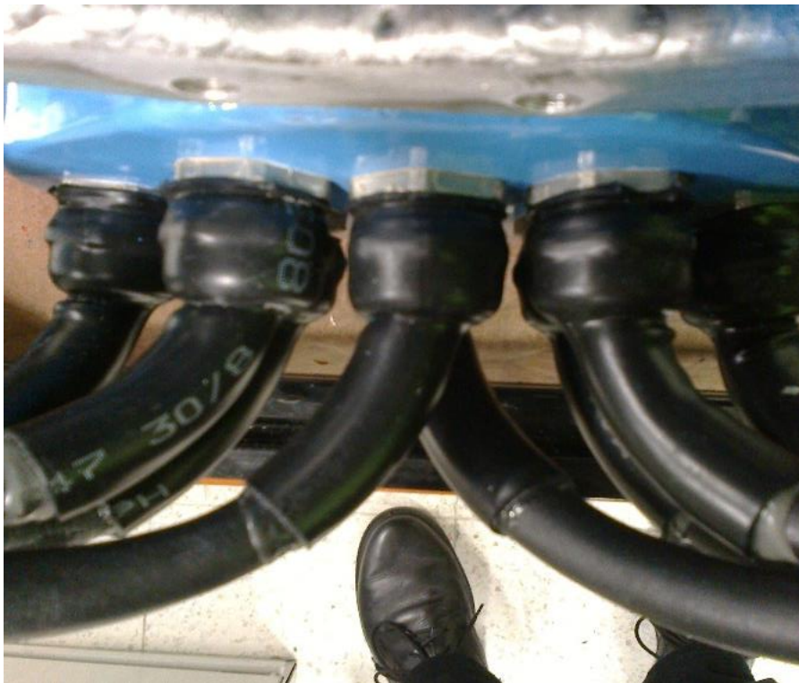
Kuva 36. Alemman painerungon pullistumat painetestin jälkeen
