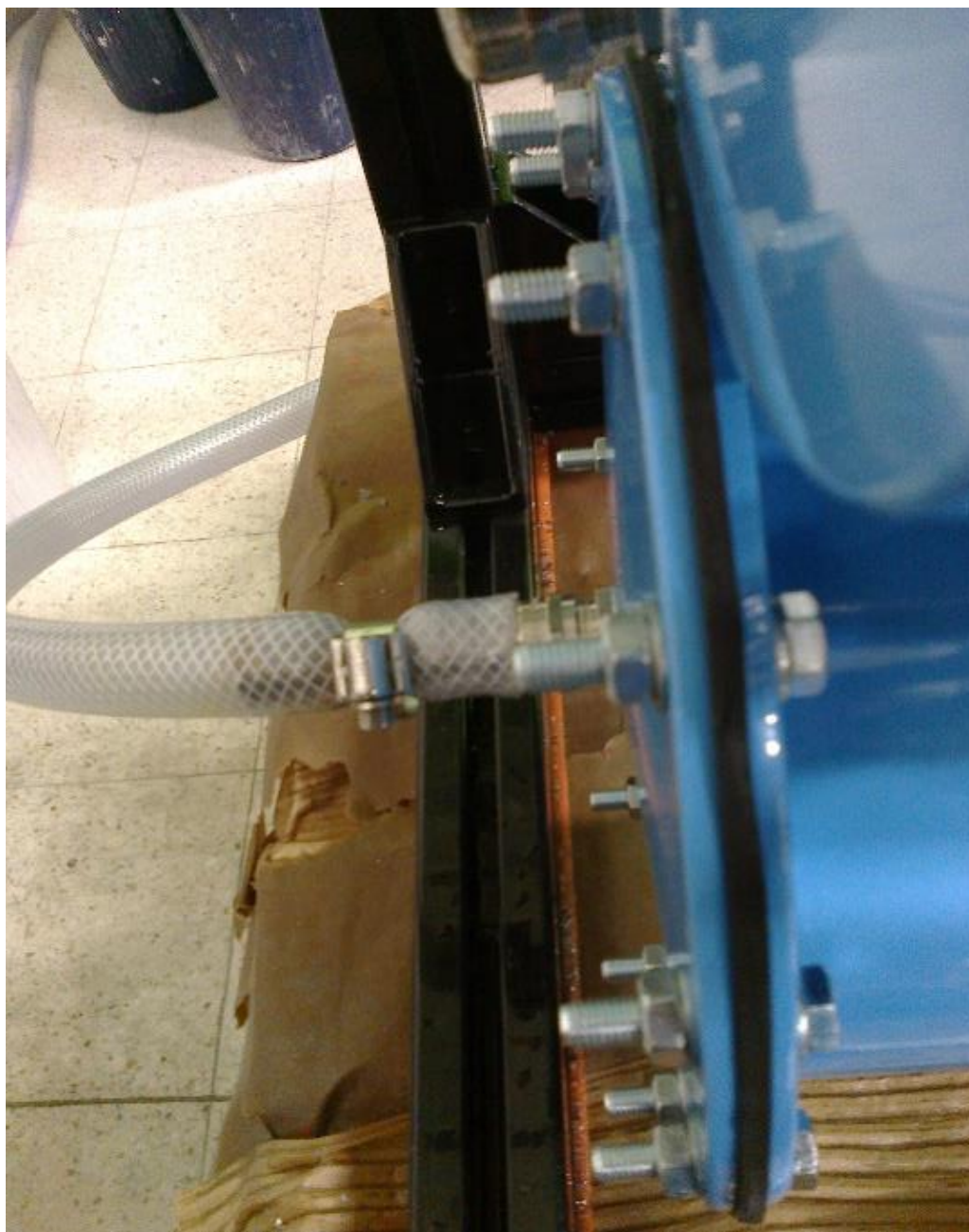
Kuva 37. Alemman painerungon laipan pullistumat painetestin jälkeen
