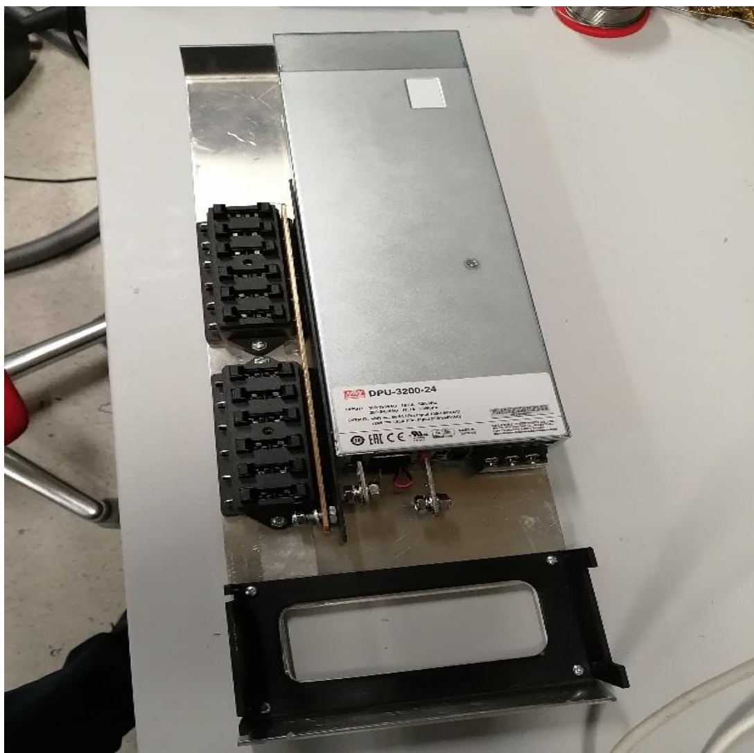
Kuva 11. Virtalähde, sulakerasiat sekä 3D-tulostettu kiinnike vielä tässä vaiheessa kahdeksalle ohjainkortille.
