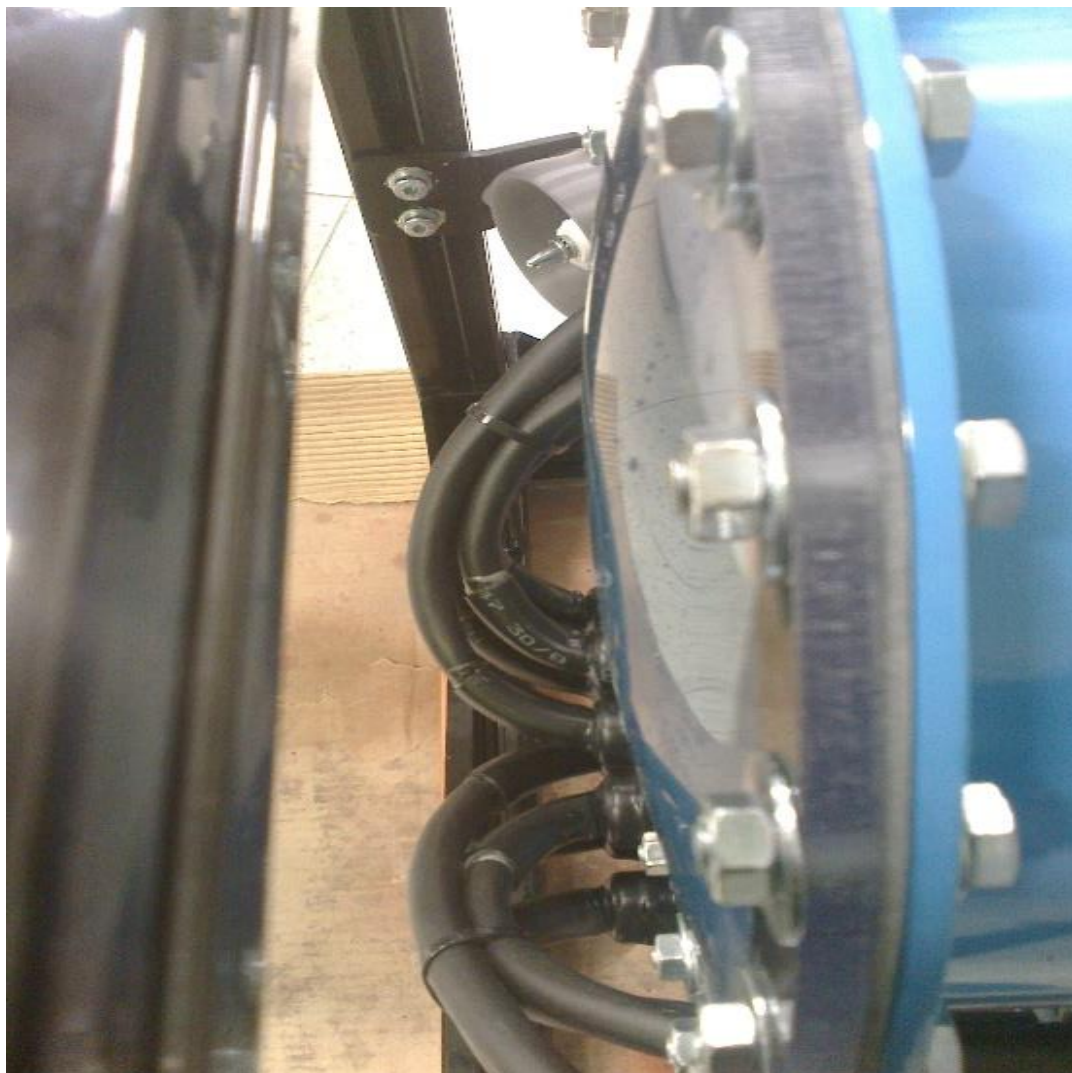
Kuva 34. Ylemmän painerungon polykarbonaattilaipan (linssin) pullistumat painetestin jälkeen. Laippaa tukevan kauluksen puuttuminen ei kuitenkaan aiheuttanut testin aikana vuoto ongelmia.
