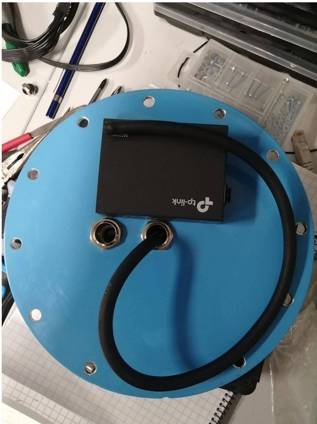
Kuva 22. Mallinnus kaapelin ja rj45-kuitumuunninkotelon sijoittamisesta
