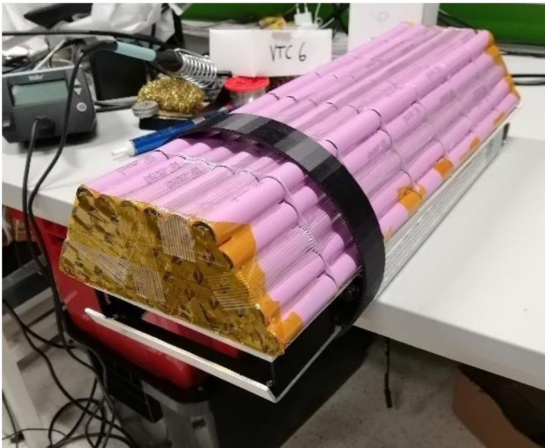
Kuva 14. Akku ja päävirtalähde koottuna samaan pakettiin
