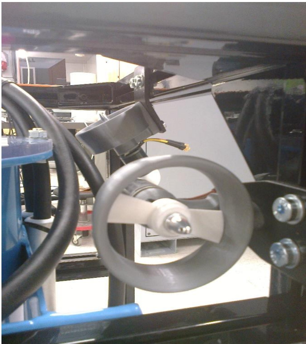
Kuva 18. Potkurilaitteet ja niiden kaksi eri kiinnitystapaa
