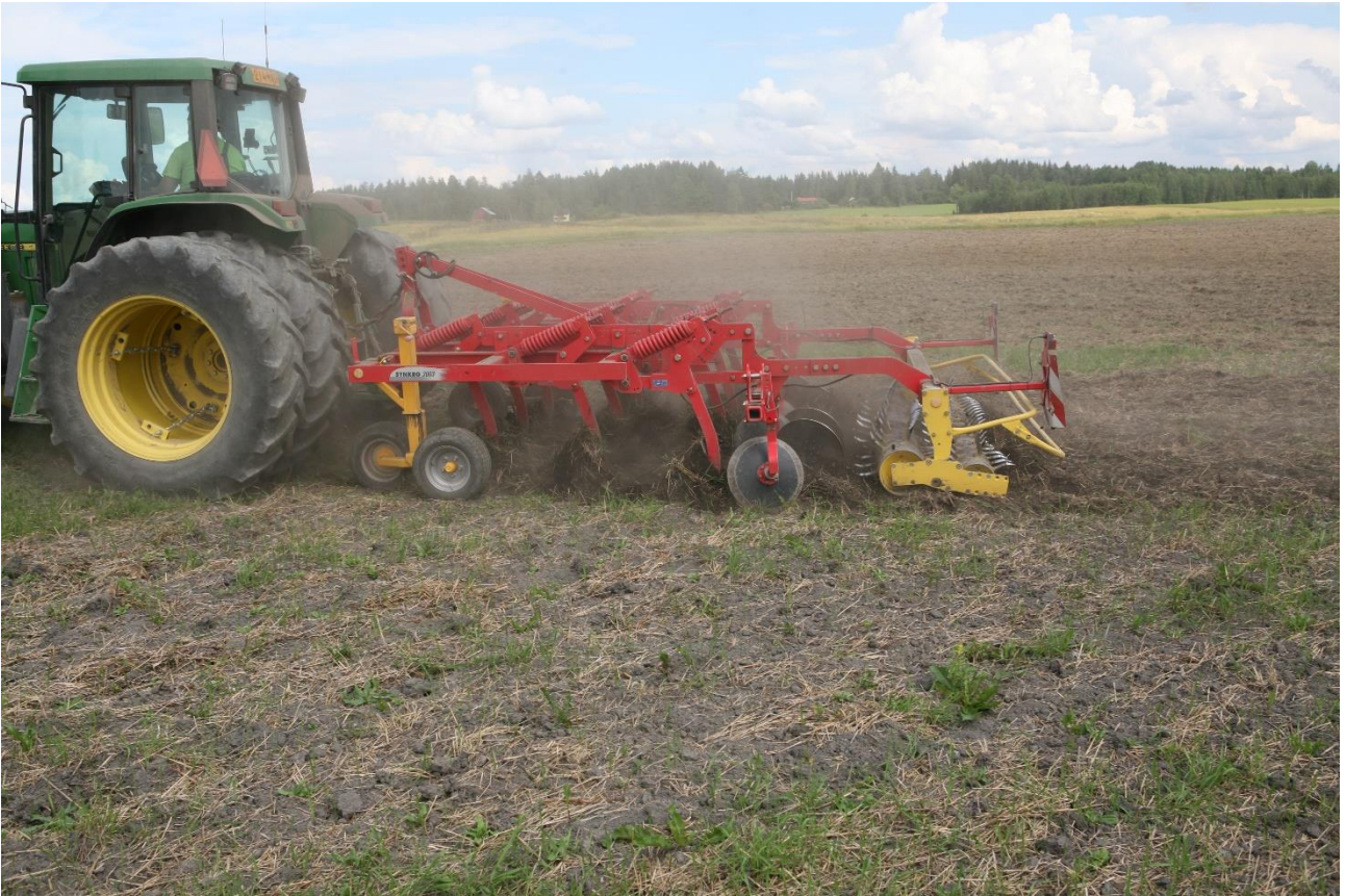
Kuvio 5. Pöttinger Synkro 3003 varustettuna koneen perässä näkyvällä piikkipakkerilla. (Tyynelän tila n.d)
