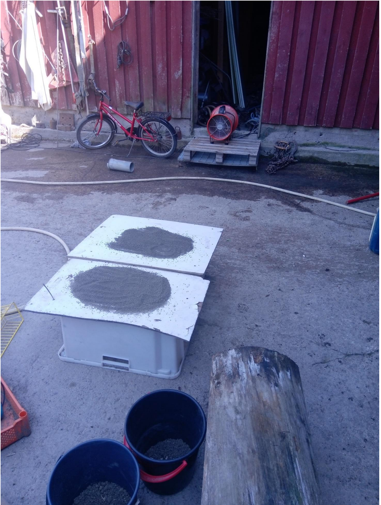
Kuvio 22. Murustettujen hiilidioksidi hengityskiekkojen tuuletus.
