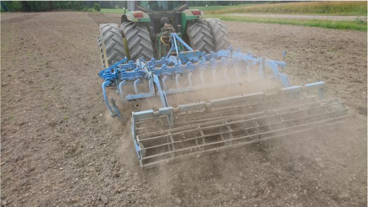
Kuvio 12. Lemken rubin Lautasmuokkain 3 metrin työleveydellä (Tyynelän tila n.d.).
