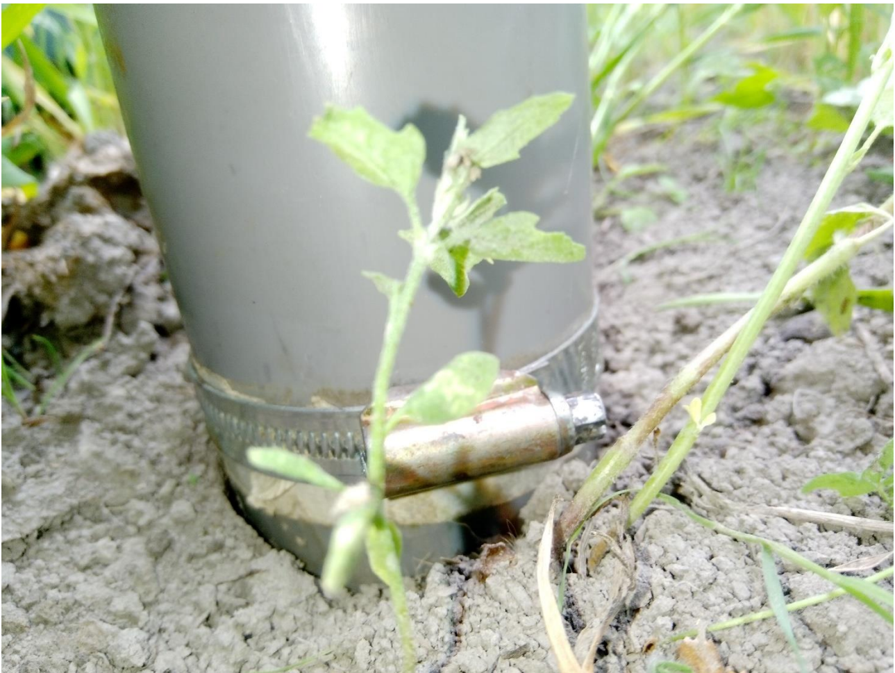
Kuvio 20. Maanäytteen otto salaojaputken pätkällä, putki on halkaistu ja kiristetty letkukiristimellä joka löystytetään kiekon irroittamisen helpottamiseksi.
