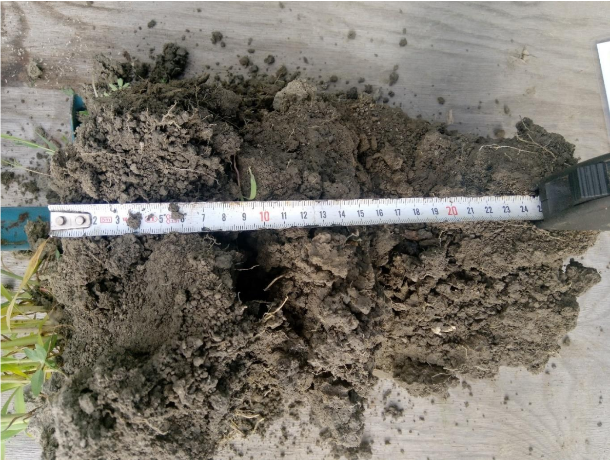
Kuvio 42. Maanäyte suorakylvetyltä koealalta. Kuvassa näkyy kynnettyä parempi mururakenne ja yhtenäisempi koostumus koko näytteen syvyydeltä.
