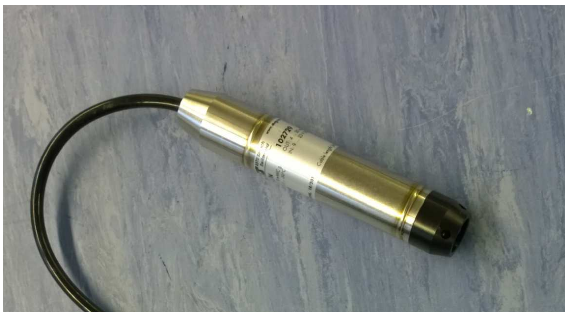
KUVA 3 TST-tyyppinen pinnankorkeusanturi (Nieminen 2014.)
