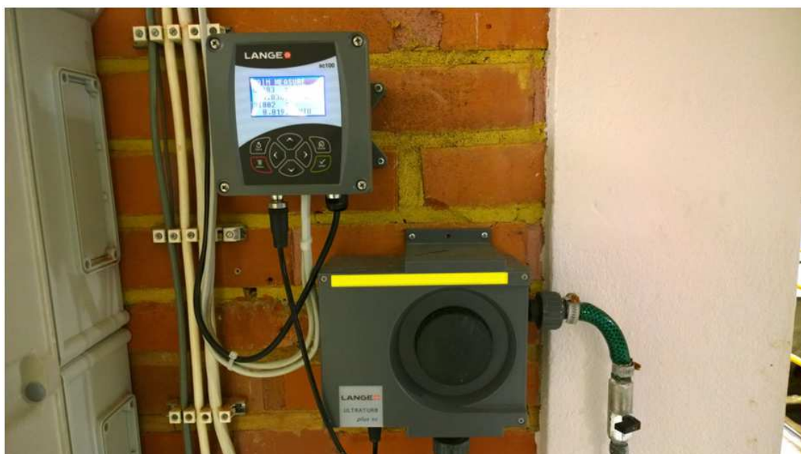
KUVA 1 Ultraturb SC plus-sameusanturi (alla) ja sc100 mittalähetin (Nieminen 2014.)
