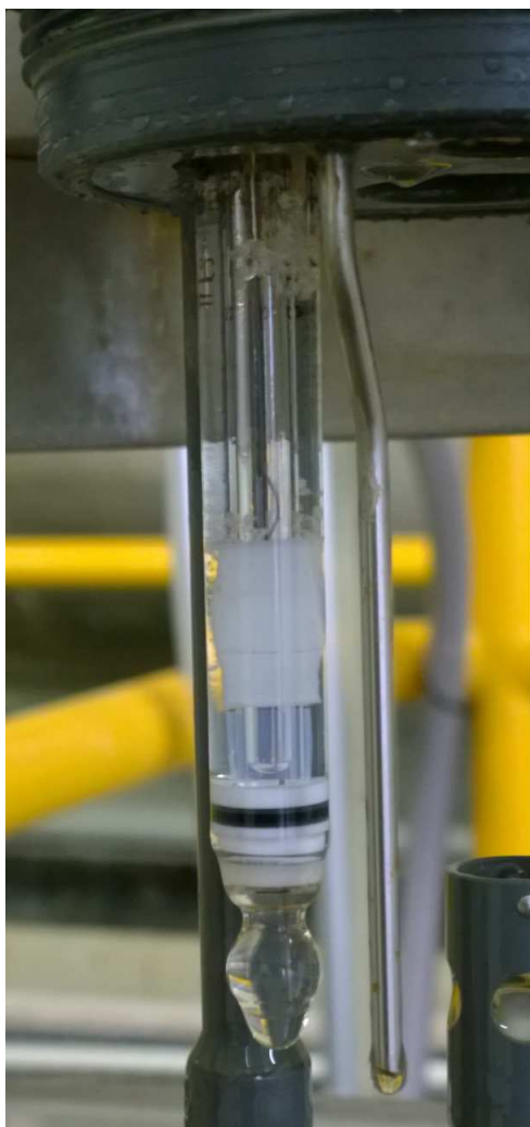
KUVA 2 Lasikalvoinen pH-anturi (Nieminen 2014.)
