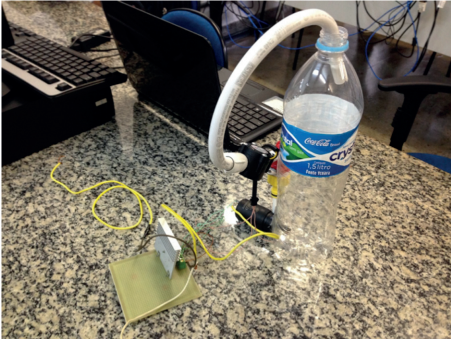
Figura 5. Protótipo de Controle de Nível desenvolvido
