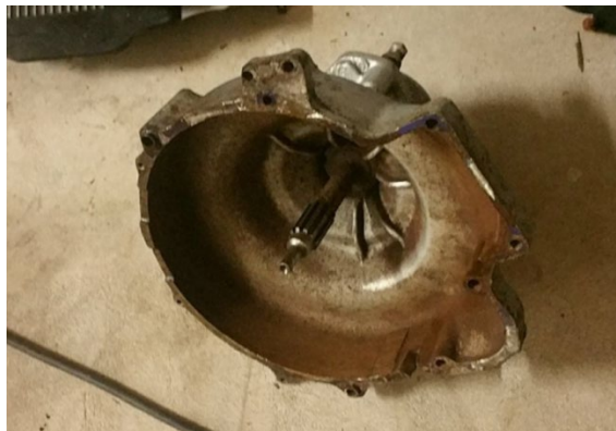
Kuva 17. Vanha kytkinkaaveli jossa uuteen laippa-akseliin sopiva ura-akseli
