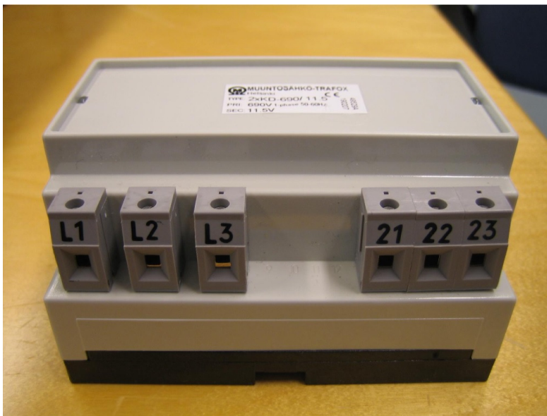
Kuva 16. OPT-7D-kortin toimitukseen kuuluva mittausmuuntaja.
