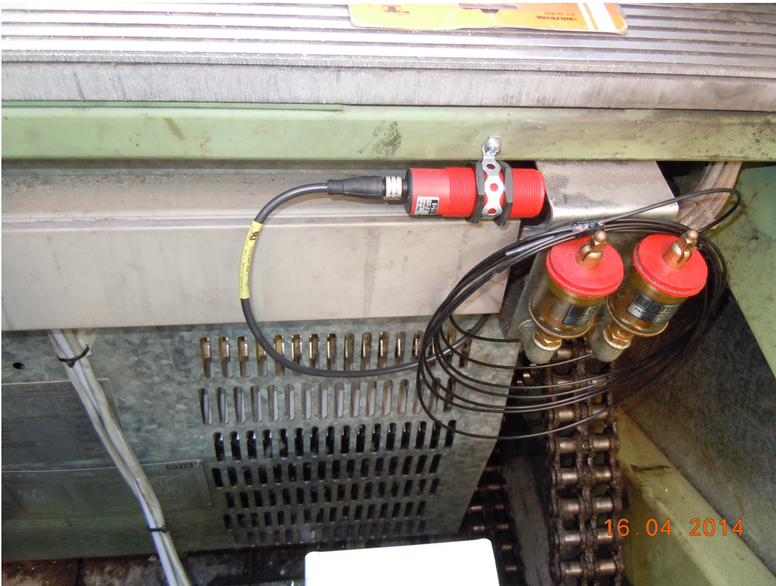
Kuva 22. Piezoanturin vahvistimen asennus.
