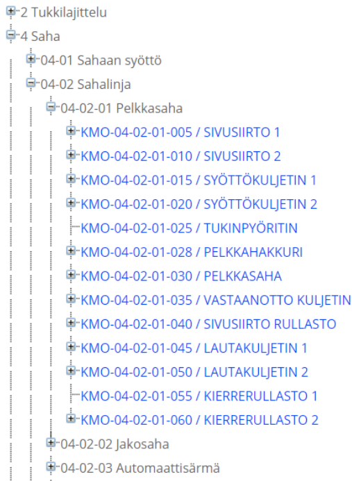
KUVA 7. Sahalinjaston alatason pelkkasahan päälaitteet
