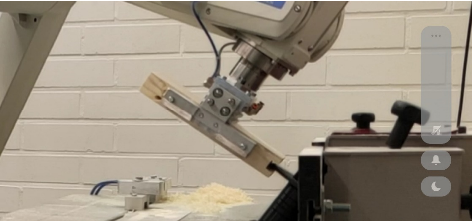
Kuva 4. Työstökappaleen jyrshintää robotilla
