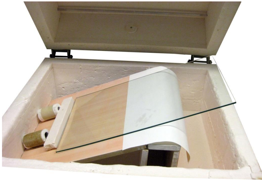
Kuva 10. Uuden muodon lämpömuovauskokeilu menossa taivutukseen
