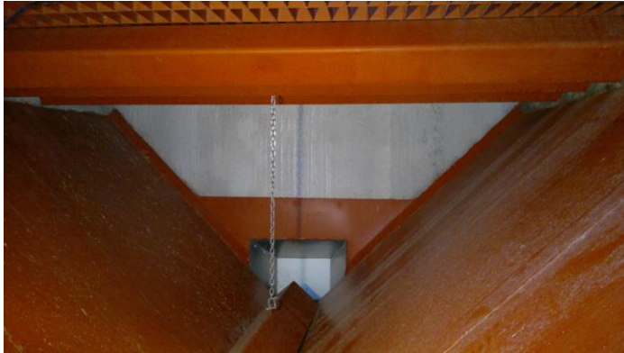
Kuva 29. Kaatoallas jonka pohjalla on työntävä ruuvi elevaattorille
