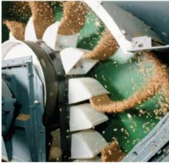
Kuva 4. Läpileikkaus elevaattorin yläosasta [6.]
