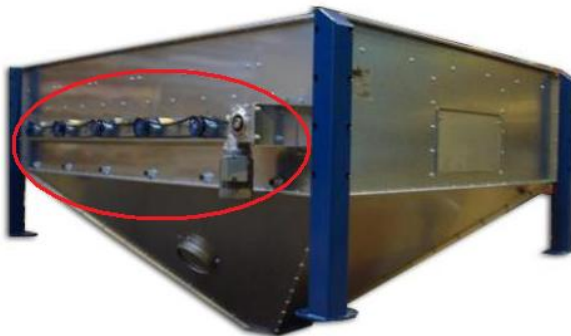
Kuva 11. Kuivurin jalusta, jossa syöttölaite on korostettuna [12.]
