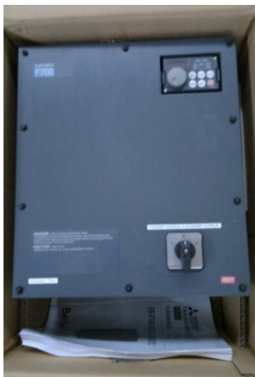
Kuva 33. Elevaattorin moottorille asennettava taajuusmuuttaja
