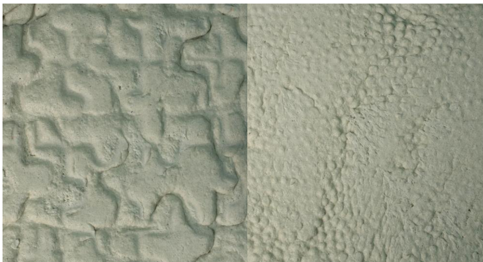
Kuva 24. Vasemmanpuoleinen kappale on liikkunut vaahdottuessaan ja muotin kuvio on muuttunut aivan uudennäköiseksi. Samoin on käynyt toisessakin esimerkissä, mutta vaikutelma on hyvin erityyppinen.
