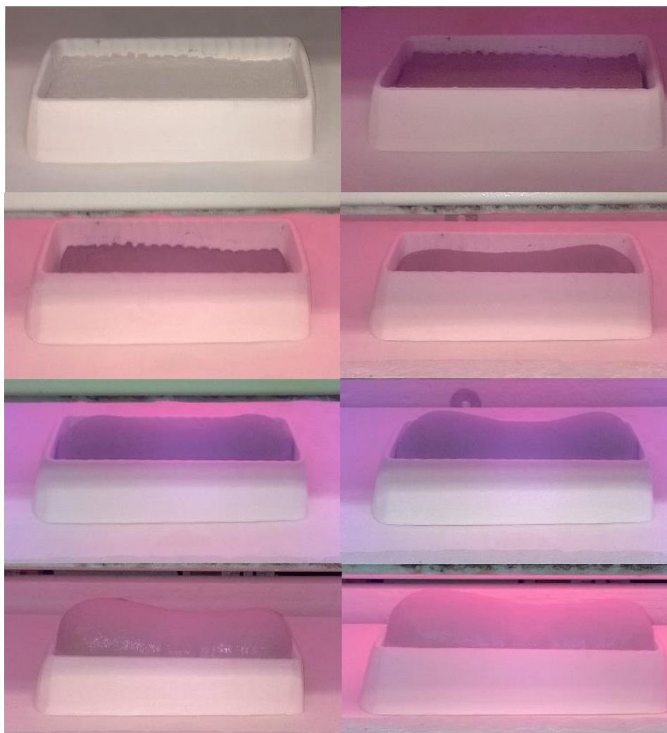
Kuva 12. Vaahdottumisprosessista otetut kuvat osoittavat, kuinka massa lähtee aluksi sintraantumaan ja kutistuu, minkä jälkeen vaahdottuminen alkaa ja kappale muotoutuu hyvin nopeasti maksimikokoonsa.
