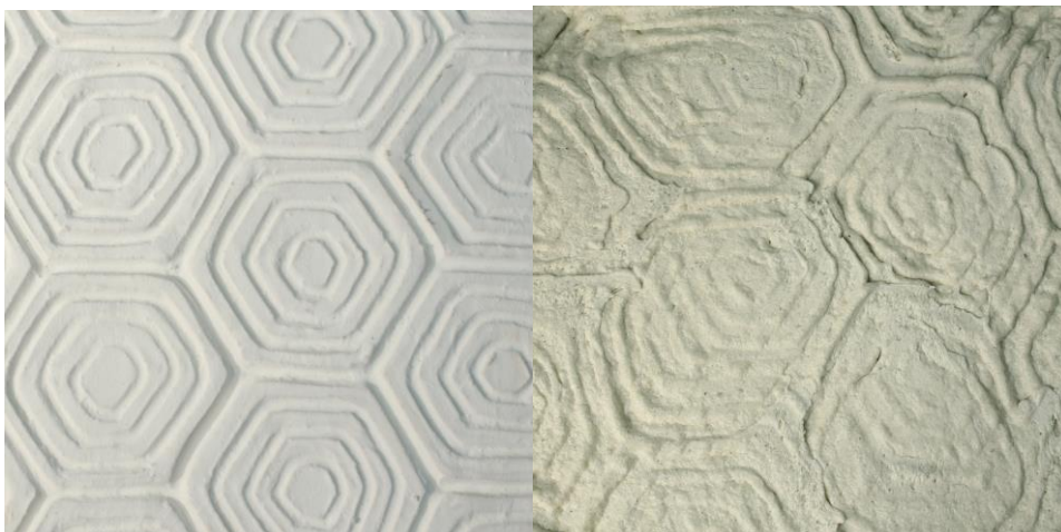
Kuva 13. Massa (oik.) on liikkunut vaahdotuessaan aiheuttaen sen, että muotin kuvio (vas.) on siirtynyt kappaleeseen epätasaisesti. Joissakin kuvioissa tämä voi olla hyväksyttävää ja visuaalisesti kiinnostavaa, mutta esimerkin kaltaisissa säännöllisissä aiheissa lopputulos näyttää ainoastaan epäonnistuneelta.
