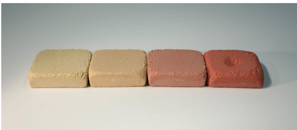
Kuva 16. Värikokeessa käytetyt pigmentit ja määrät. A: R407 2 % + FK5001 2 % B: FK5001 4 % C: FK5001 2 % + FK6904 2 % D: FK6904 5 %.
