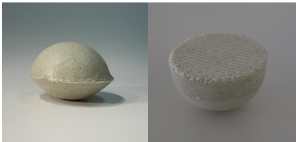
Kuva 25. Kulhomaisissa muoteissa vaahdotettuja vaahtolasikappaleita. Vasemmalla on vapaasti ylöspäin vaahdotunut muoto. Oikeanpuoleinen kappale on vaahdotunut kansilevyyn ja hakeutunut täyttämään myös muotin kulmat.
