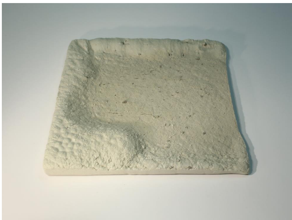
Kuva 22. Hyvä esimerkki lämpötilaerojen vaikutuksesta vaahdottumiseen. Kappaleen oikea reuna on vasta sintraantumisvaiheessa, kun vasen puoli on osittain vaahdottunut jo muotin yläreunaan asti.
