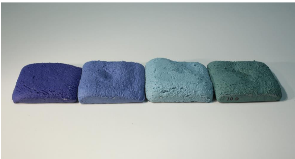
Kuva 14. Värikokeessa käytetyt pigmentit ja määrät. A: K4628 4 % B: K4628 1 % + FK243 2 % C: FK243 3 % D: FK243 3 % + K2297 1 %. Huonolaatuinen vaahdottuminen johtuu vääränlaisesta poltto-ohjelmasta. Edellä luetellut pigmentit eivät vaikuttaneet vaahdottumiseen.
