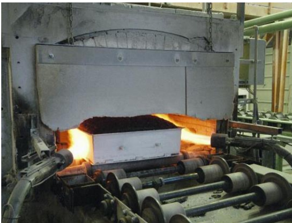
Kuva 6. Teräsmuotissa vaahdotettu vaahtolasikappale tulossa uunista Pittsburgh Corningin tehtaalla. (Foamglas Eristysjärjestelmät koko rakennukseen n.d.)
