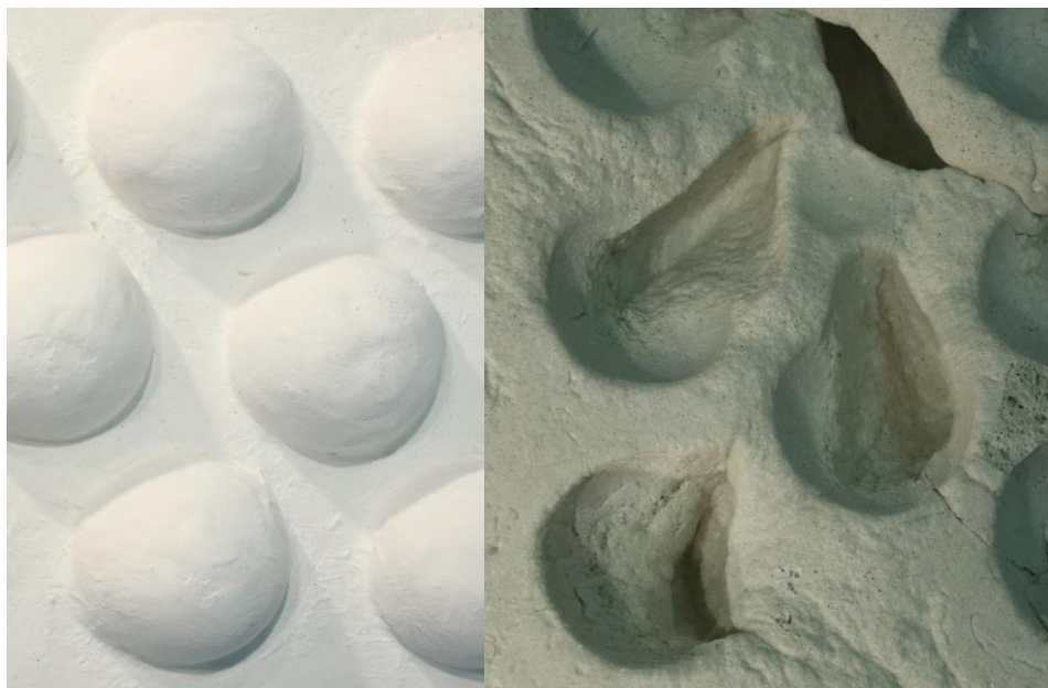
Kuva 27. Vasemmalla muotin suurikokoisia pallokuvioita. Vaahdotuskoe tehtiin kuviopinta alaspäin. Oikealla tulos vaahtolasikappaleessa.
