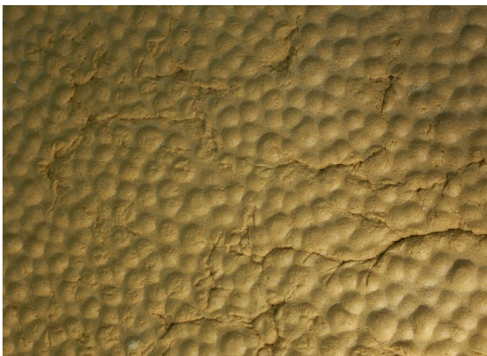
Kuva 28. Suurikokoinen muotissa vaahdotettu vaahtolasilaatta. Nähtävissä on jonkin verran epätasaisuuksia, mutta kappale on vaahdotunut kauttaaltaan. Pinnassa on ohut värikerros.
