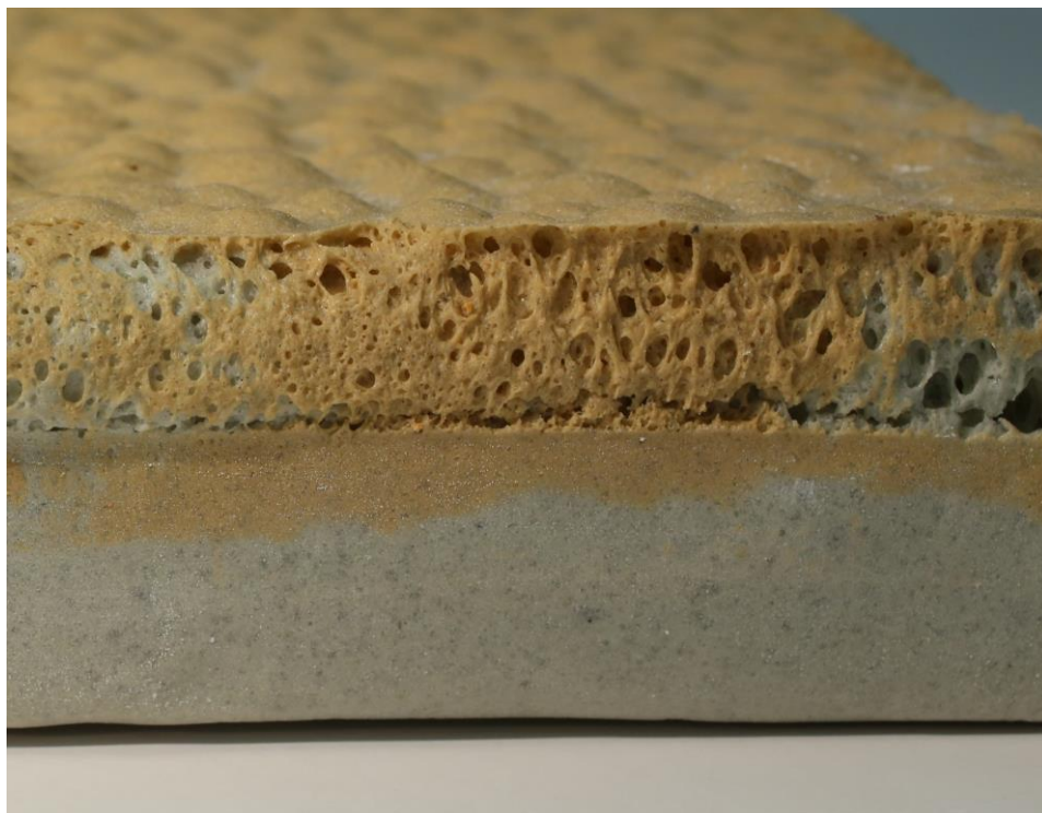
Kuva 23. Massa on kuumentunut yläpuolelta liian paljon ja kuplat ovat päässeet pintakerroksen läpi. Tällainen huokoinen pinta imee kosteutta ja likaantuu helpommin kuin tiivis. Lisäksi suuret kuplat tekevät rakenteesta hauraamman.
