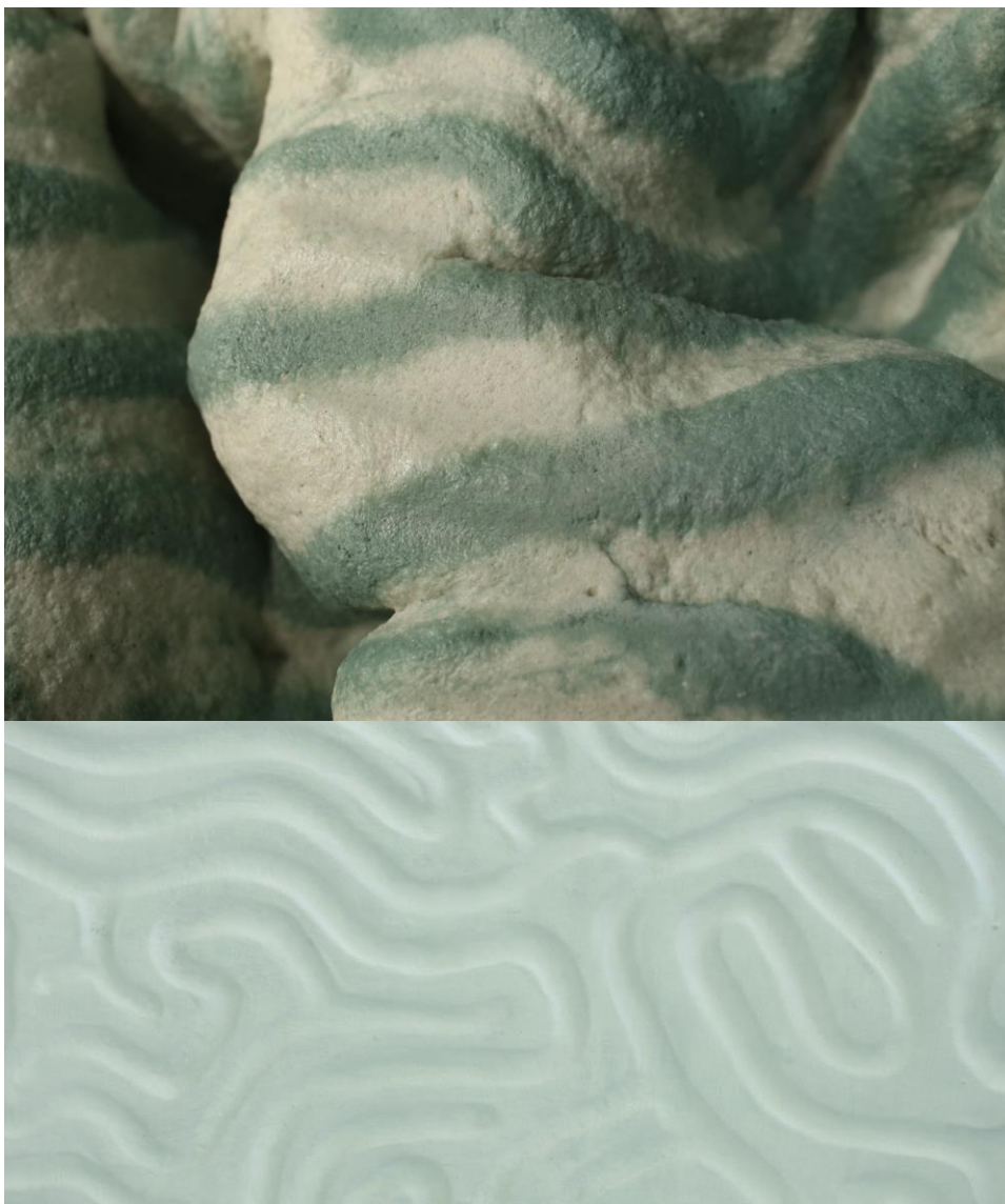
Kuva 20. Kokeilu värjätyillä seoksilla ja reliefipinnalla kuvioinnista. Tasainen vaahdotuminen epäonnistui, minkä vuoksi värialueet siirtyivät pois kohdiltaan.
