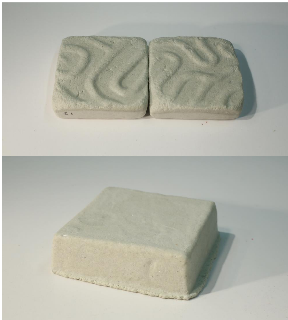
Kuva 26. Pienempikokoiset, 80 x 80 mm, laatat vaahdotuivat tasaisesti muotin mukaisesti.
