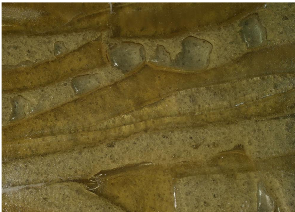
Kuva 21. Värillisiä tasolasin paloja yhdessä ja kahdessa kerroksessa vaahtolasin pinnalla. Vaahtolasin kuplarakenne on jäänyt näkyviin ja erottuu tasolasin läpi.
