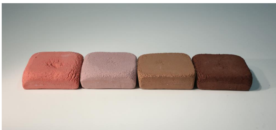
Kuva 17. Värikokeessa käytetyt pigmentit ja määrät. A: FK6904 5 % + K4272 2 % B: K4272 5 % + 4704 3 % C: FK5001 5 % + 4175 1 % D: 4175 6 %
