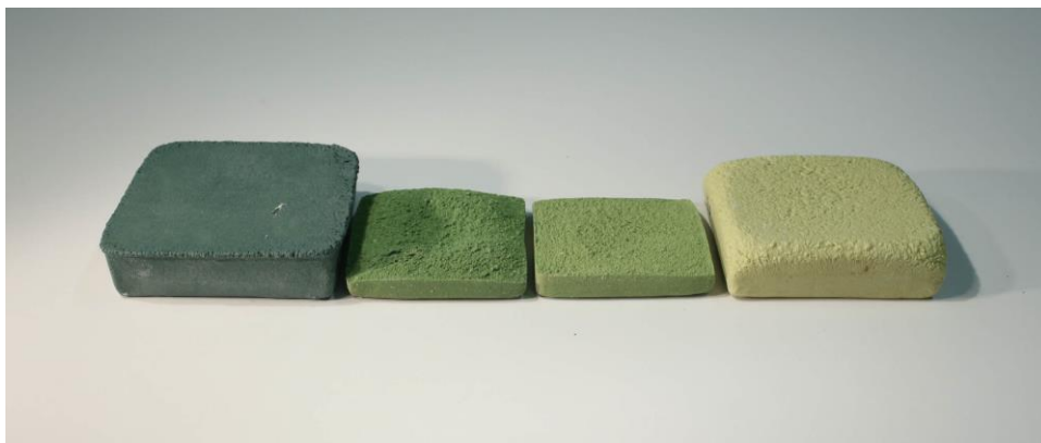
Kuva 15. Värikokeessa käytetyt pigmentit ja määrät. A: K2297 3 % B: R522 2 % C: R522 1 % + R407 3 % D: R407 4 % . Kromipitoinen vihreä pigmentti esti vaahdottumisen täysin, ainakin käytetyssä lämpötilassa
