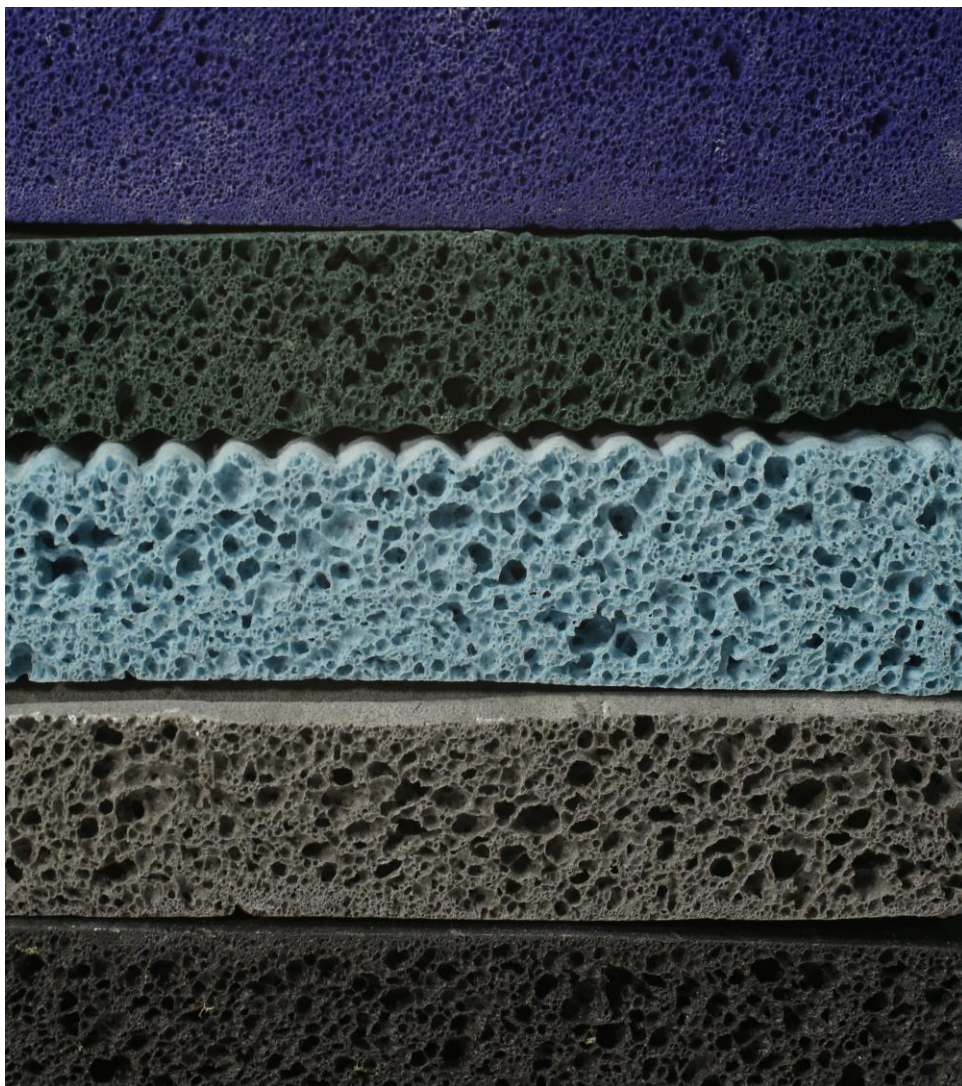
Kuva 18. Ylintä kappaletta lukuunottamatta eri väriaineet eivät ole vaikuttaneet kuplarakenteeseen.
