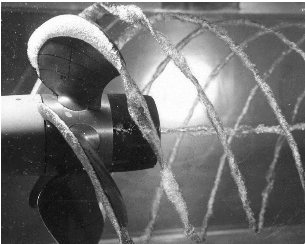
Kuvio 12. Havaintokuva voimakkaasta kavitaatio ilmiöstä.
