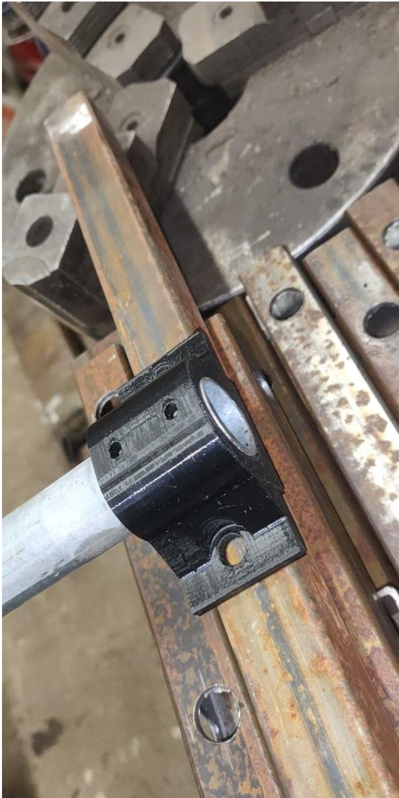
Kuva 24. Pystyseläköjen alareunassa olevat ohjurit: Auttavat seläköjä pysymään staabiilina, koska kiinnitys ainoastaan ylhäältä.
