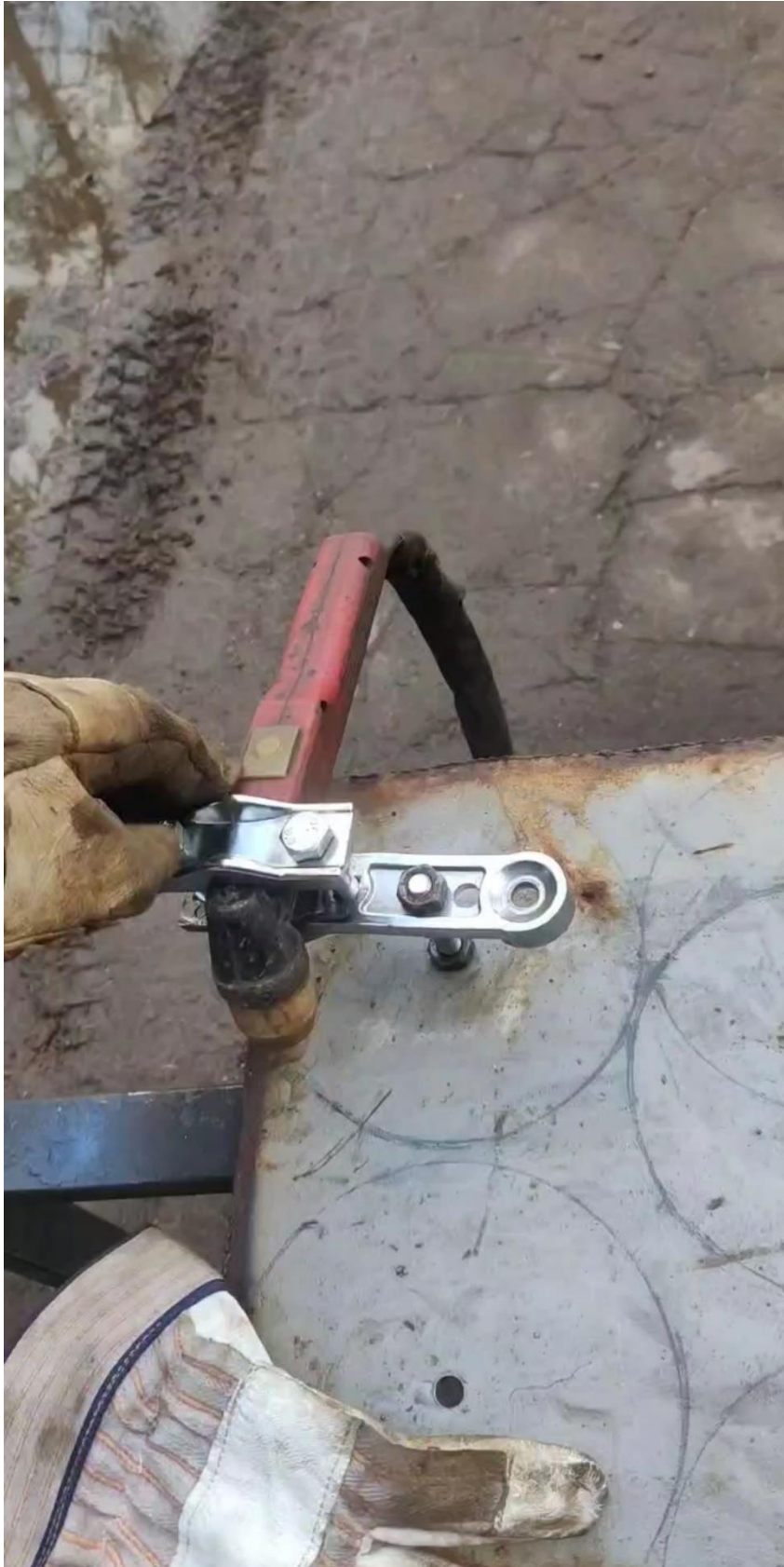
Kuva 21. Kehikon tassujen leikkausta plasmalla.
