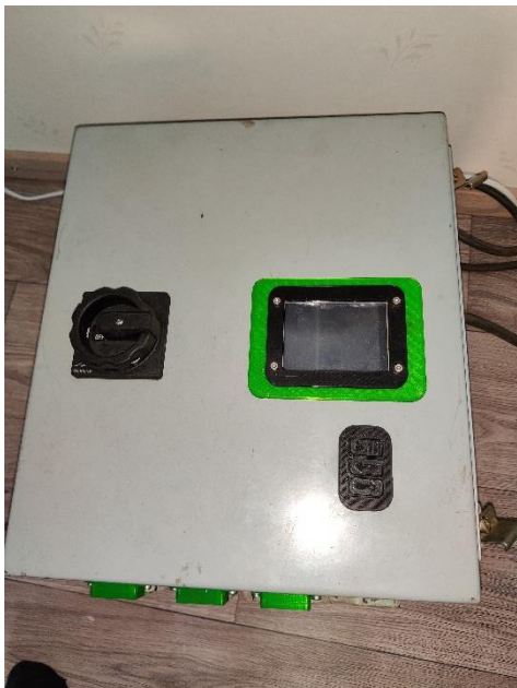
Kuva 12. Keskuksen kannesta löytyy pääkytkin, pieni 3.2” LCD -näyttö sekä painikkeet käyttöliittymän käyttöön.
