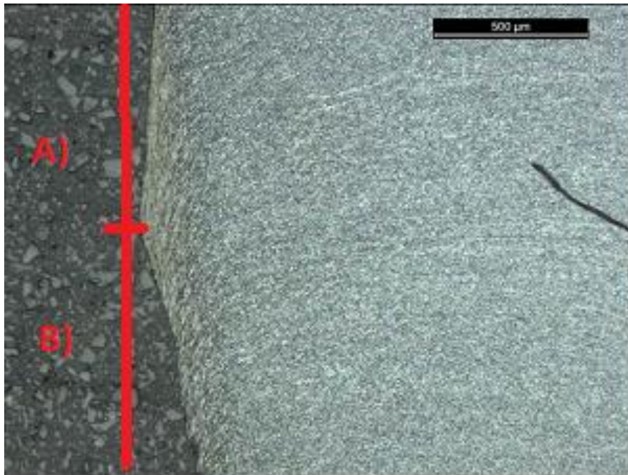
Kuva 26. Leikkausprosessissa syntyneet leikkauspinnan osat: A) kiillottunut ja B) murtunut alue.
