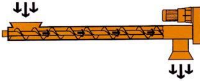
Kuva 7. Ruuvikuljettimen toimintaperiaate (huber www-sivut 2014, hakupäivä 18.4.2014)
