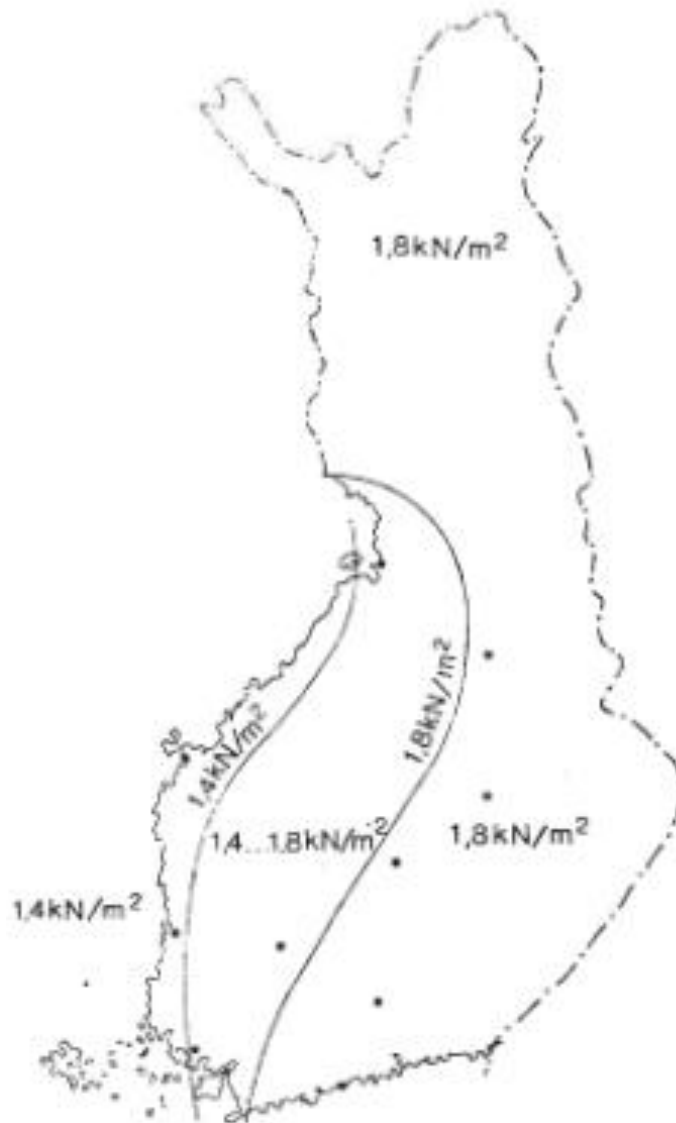
Kuva 35. Lumikuormat katoilla 1978 mukaisesti (Sisäasiainministeriö 1978).
