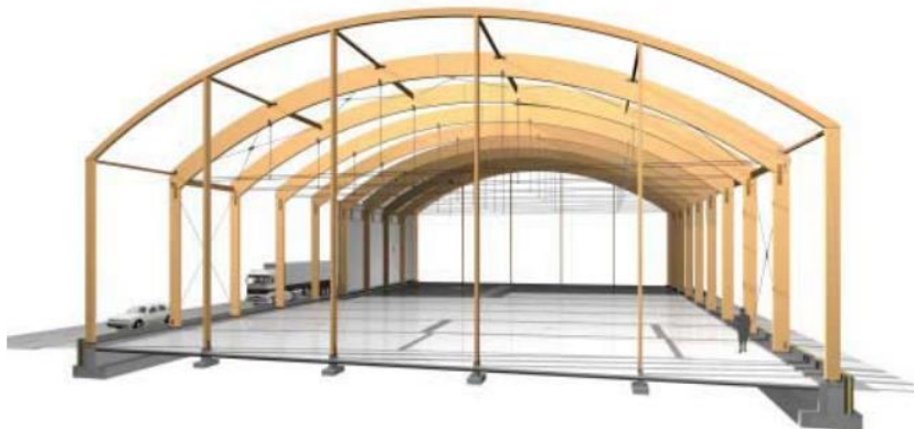
Kuva 13. Kaarirungot voivat olla myös pilareiden päällä (Puuinfo 2009).
