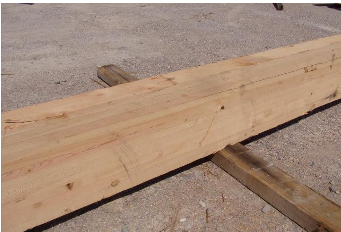
Kuva 57. Liimapuupalkki valmis uudelleen käytettäväksi (Treslewood 2022).
