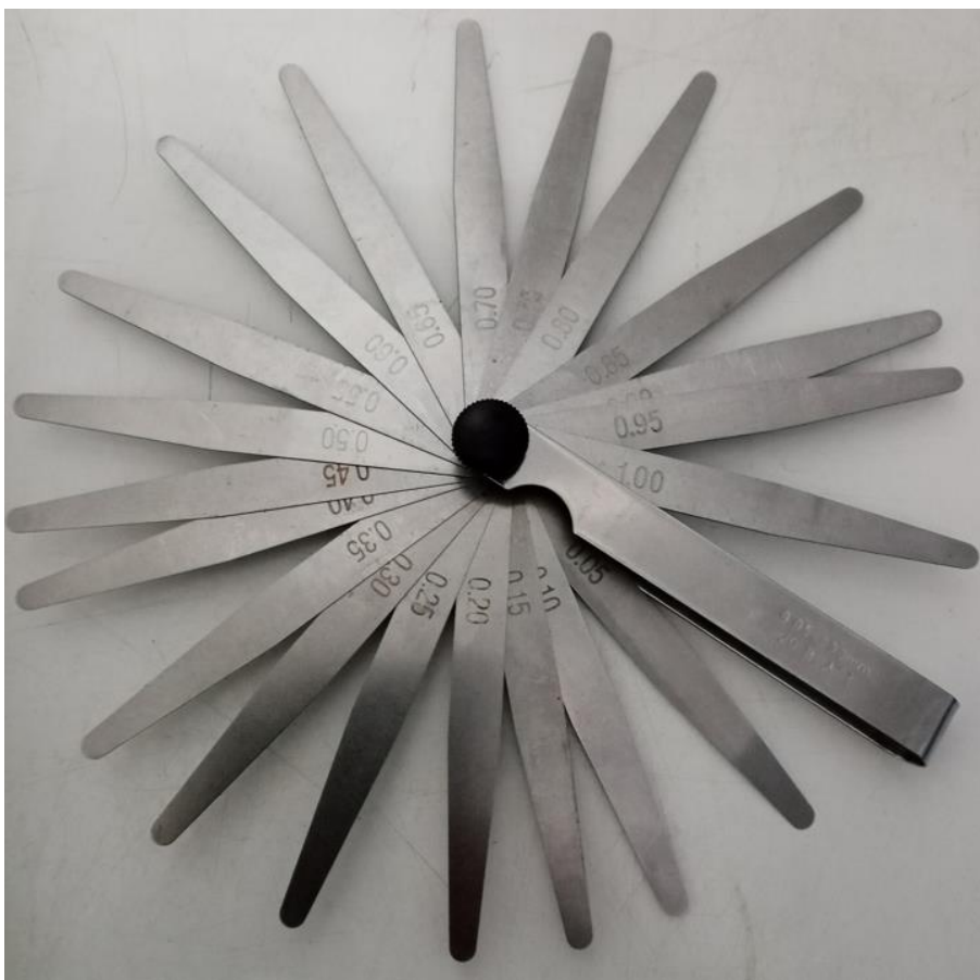
Kuva 15. Tässä rakotulkissa on mittausalueet 0,05–1 mm ja mittalehtiä on 20 kpl (Keijo Pellikka 2022).
