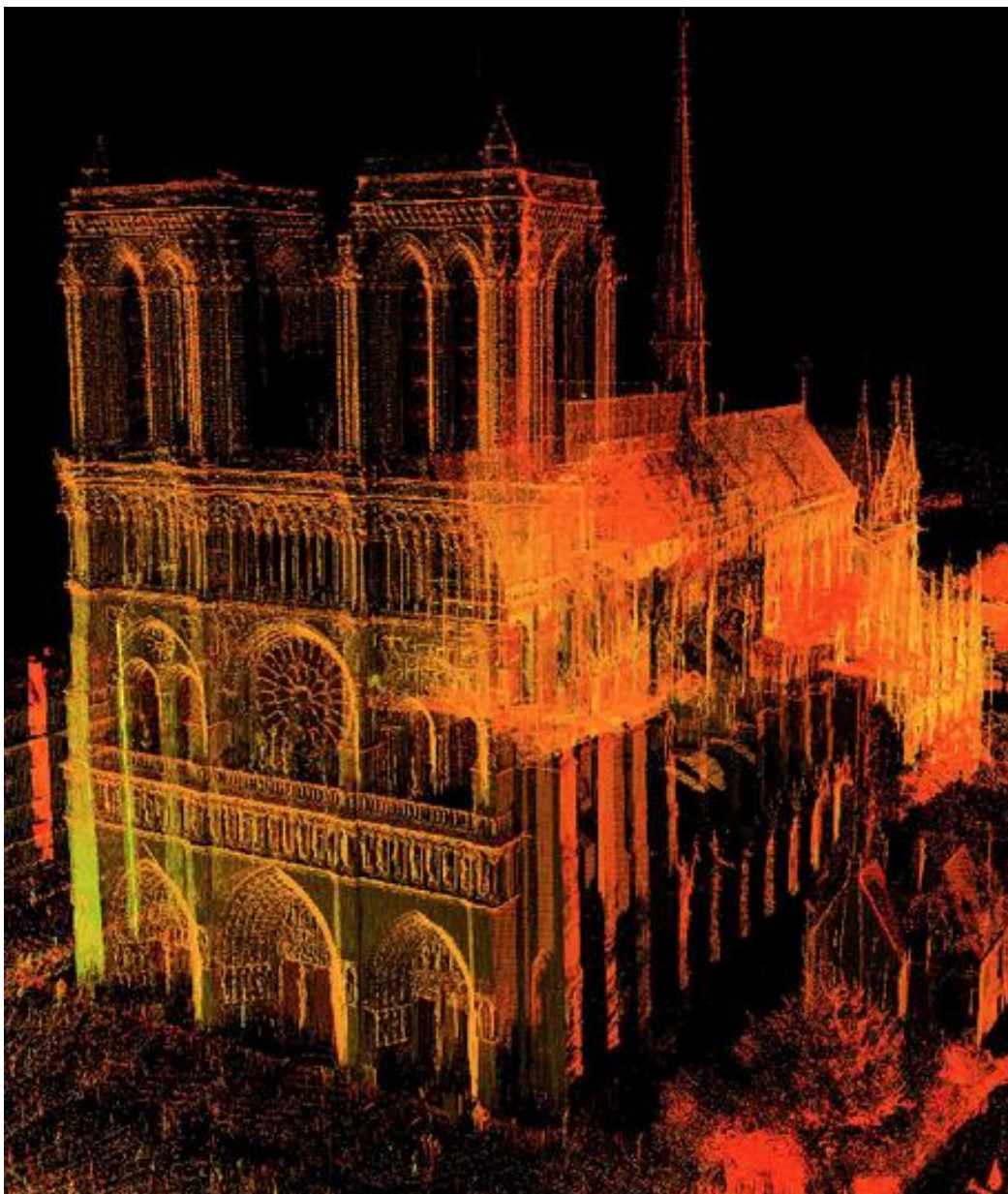
Kuva 26. Notre Damen uudelleenrakentamisessa on käytetty laserkeilausta apuna (Dan Edleson 2019).
