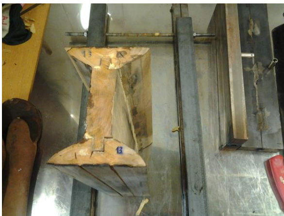
KUVIO 34. Aihio kuumamuovauksen jälkeen
