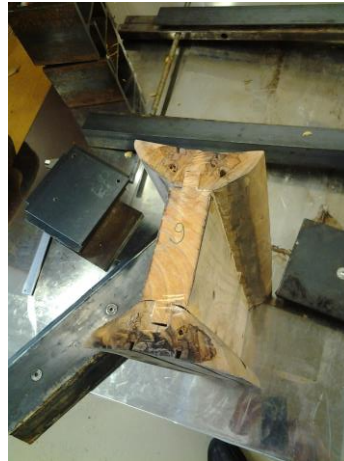
KUVIO 28. Aihio pari päivää puristuksen jälkeen
