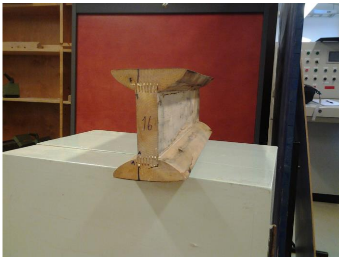
KUVIO 36. Aihio kuumamuovauksen jälkeen
