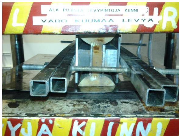
KUVIO 22. Palkkiaihiot puristimessa pystyasennossa
