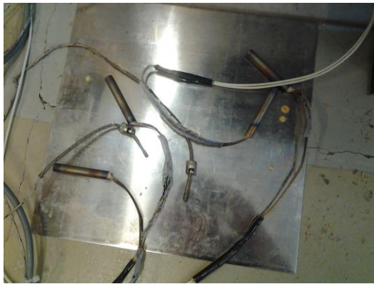
KUVIO 30. Lämmityslaitteen vastukset ja anturit
