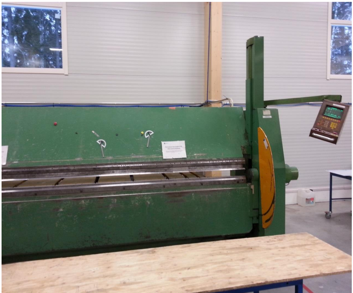
KUVA 6. Kanttikone 4 000 mm (Mielityinen 2014.)
