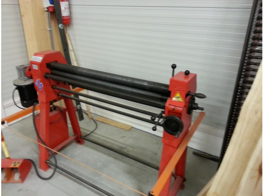
KUVA 9. Levymankeli 1 250 mm (Mielityinen 2014.)
