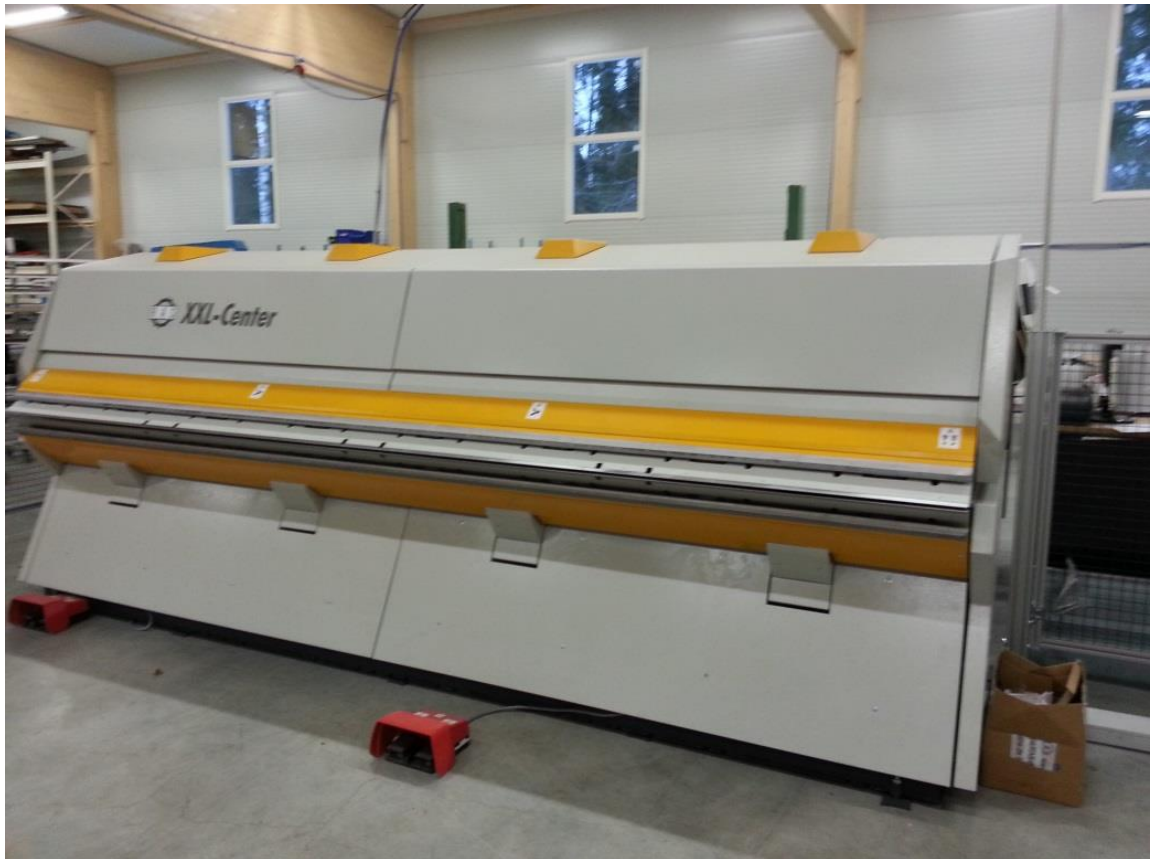
KUVA 5. RAS XXL-Turbobend (Mielityinen 2014.)
