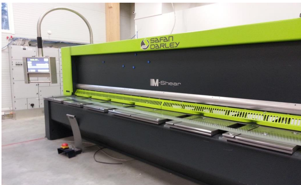
KUVA 4. Safan-levyleikkuri 4000 mm (Mielityinen 2014.)
