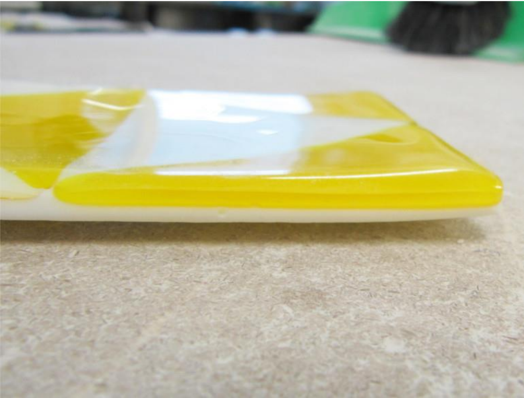
Kuva 16 Sojjakastikekulho epäonnistuneen taivutuspolton jälkeen (Mukala 2014)
