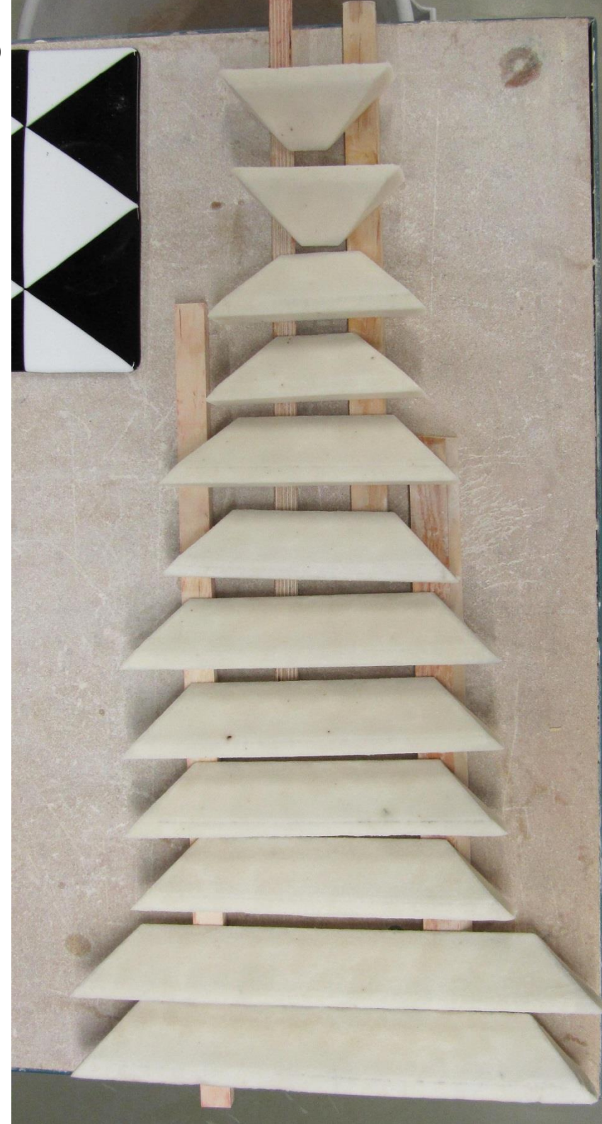
Kuva 13 Kovettimella valellut muottien kappaleet (Mukala 2014)
