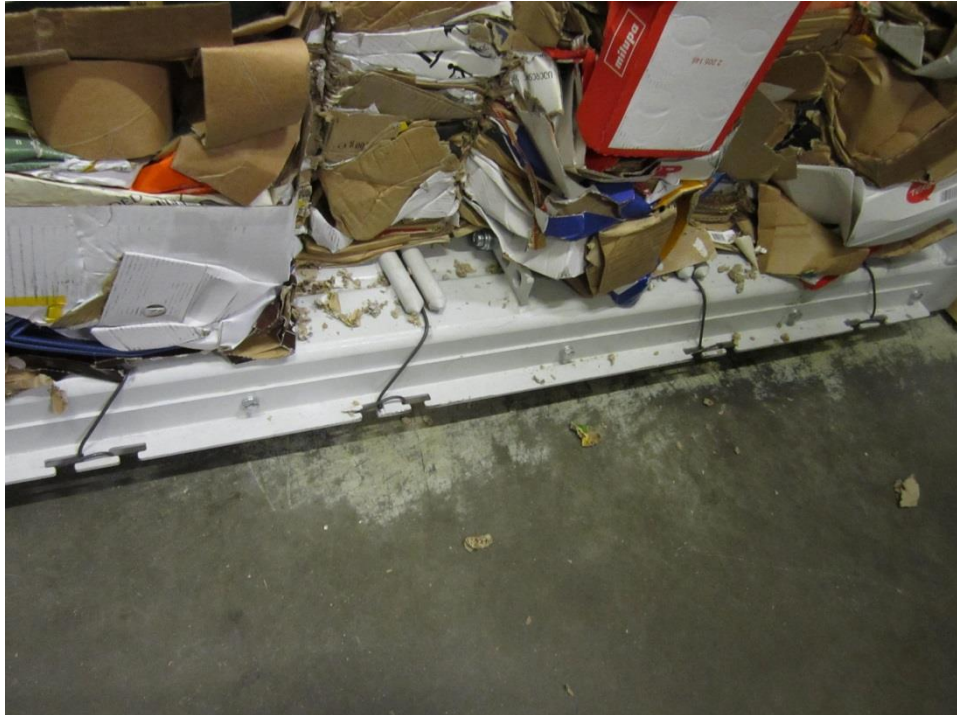
Kuva 7 Johdinurat helpottavat metallilankojen asennusta
