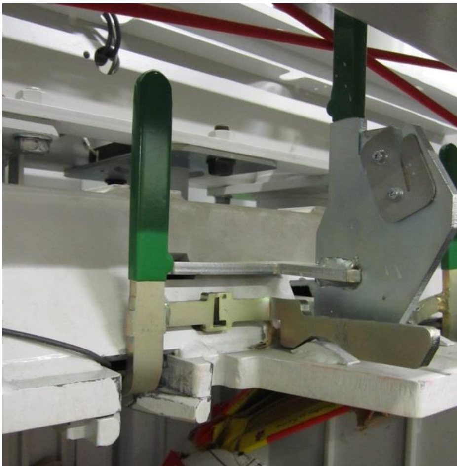
Kuva 4 Vasemanpuolinen metallilangan asennusmieikka
