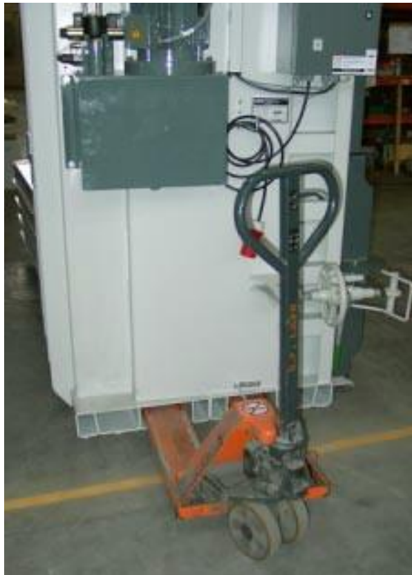
Kuva 3 Paalainta on helppoa kuljettaa pumppukärryllä.
