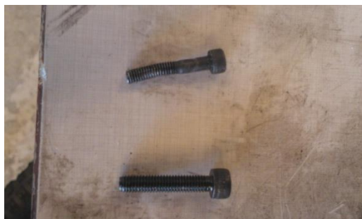
Kuva 5. Kardaaniin ja nivelakselin kiinnityspultit. Ylempänä on vanha vääntynyt 4 mm 8.8 pultti ja alempana 5 mm 12.9 pultti.
