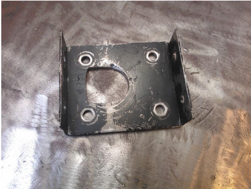
Kuva 6. Runkoputken päätylevy jyrskittyä.
