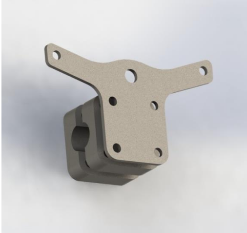
Kuva 14. Solidworks-hahmotelma ohjauslaipasta ja ohjaustangon kiinnikkeistä.
