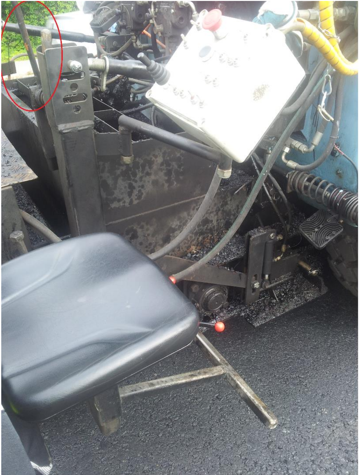
Kuva 13. Uraremixerin ohjaintaulu ja ohjaamo. Nykyinen mekaaninen nopeuden ohjaus on merkitty kuvassa punaisella. (kuva Joonas Seppänen)
