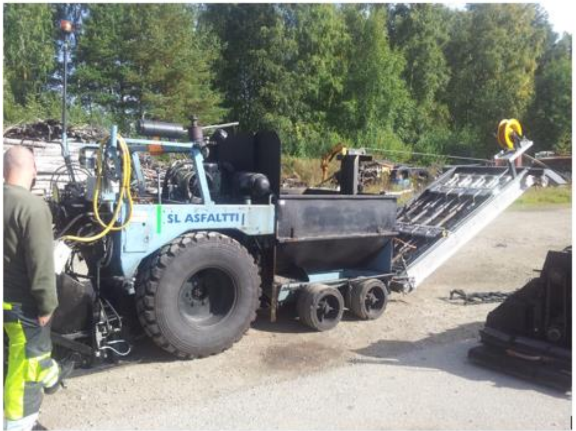
Kuva 14. Uraremixerin keulaan asennettu lisälämmitin, joka sijaitsee kuvassa oikealla. (Kuva Joonas Seppänen)
