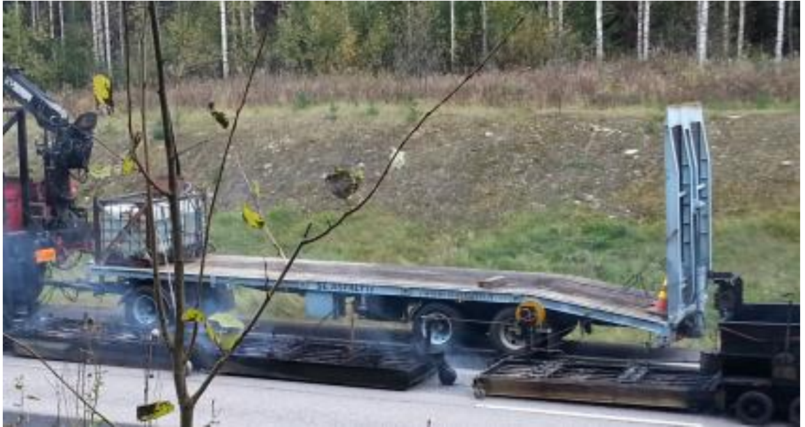
Kuva 15. Uraremix-kaluston siirtoon tarkoitettu lavetti (kuva Iris Miettinen)
