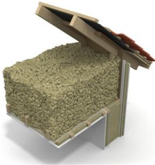
Kuva 13. Vuoden 2014 tyyppinen yläpohjarakenne. [21.]
