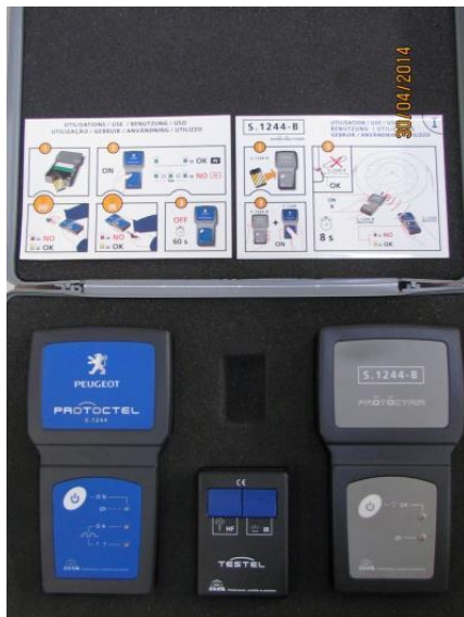
Kuva 13. Peugeot- testilaite paineanturien ja avaimen kaukosäädön sopeuttamiseen.
