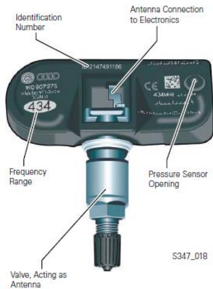
Kuva 7. 434 MHz Rengaspaineanturi [8, s. 31].
