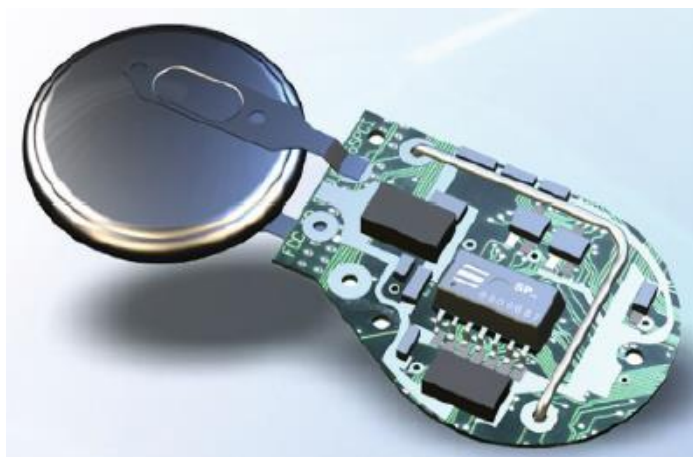
Kuva 9. Paristolla varustettu TPMS-anturi [14, s. 238].
