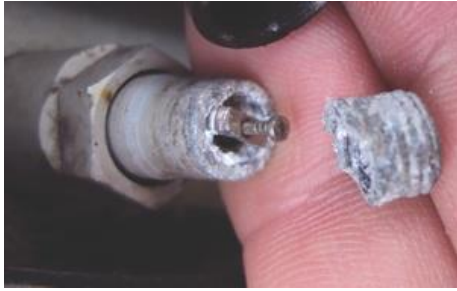
Kuva 11. Korroosion vaurioittama TPMS-sensori
