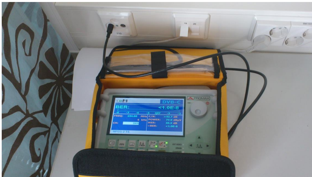
KUVA 18. Signaalitasojen ja laatuojen mittaus Promax TV Explorer II-mittarilla.
