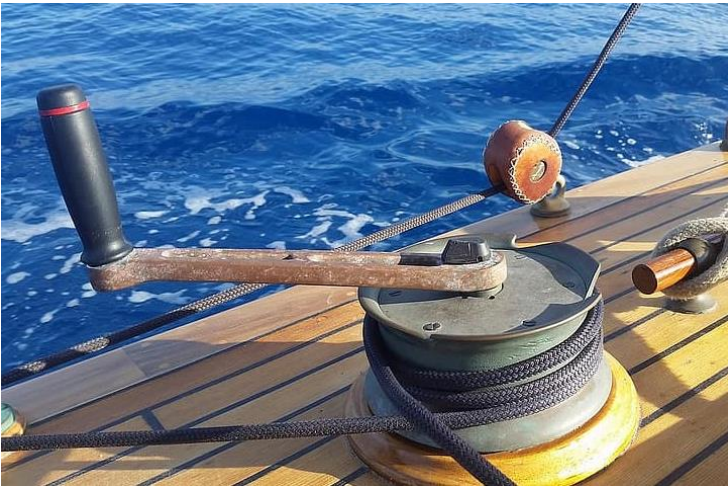
Kuvio 17. Käsikäyttöisellä yksinkertaisella vinnillä hallitaan purjeiden naruja. (kuva: Vinssi n.d.)
