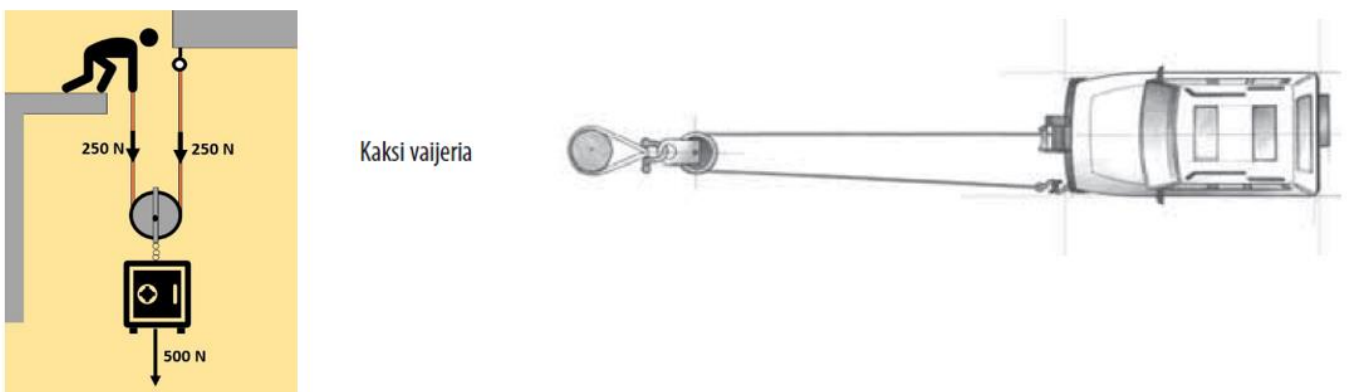
Kuvio 27. Väkipyörän avulla voiman tarpeen voi puolittaa (Työtä helpottavia koneita n.d.; Vinssitekniikoiden perusopas n.d.).
