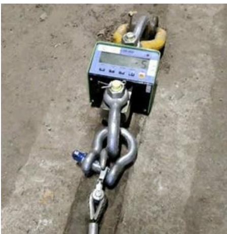
Kuvio 31. Telttahalhin lattiaan kiinnitetty lenkki ja vetokyky mittaava etäluettava vetovaaka. (kuva: Millog Oy.)
