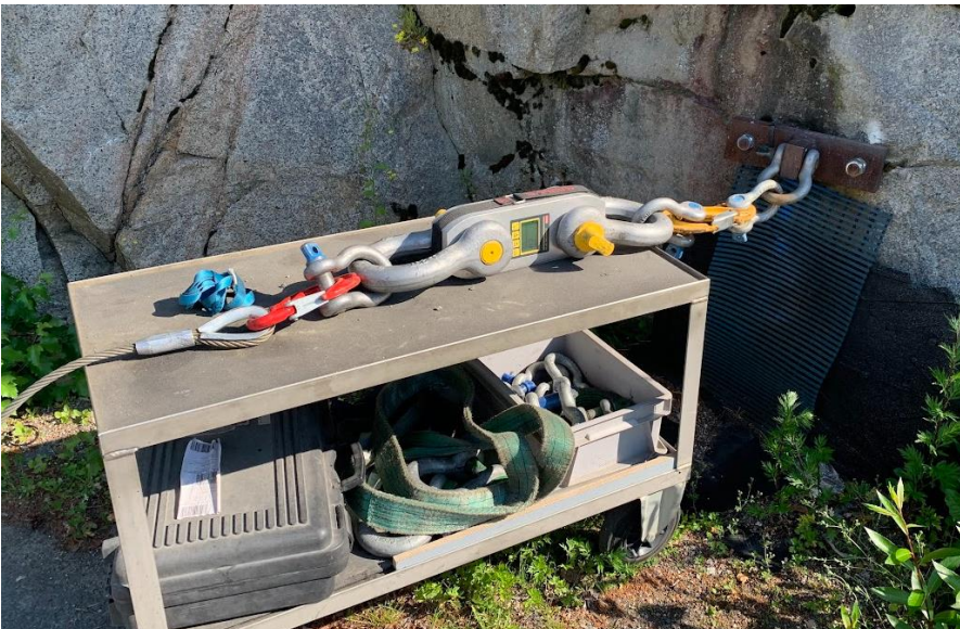
Kuvio 37. Kalliossa oleva vetolenkki ja kuormitusta mittaava vetovaaka.
