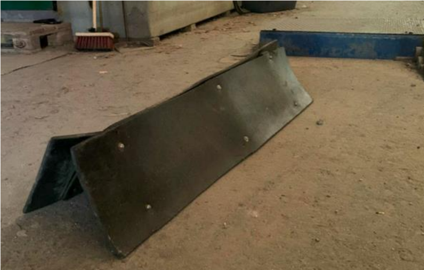
Kuvio 32. Kumisilla turvamatoilla pyritään vaimentamaan sinkoilua vaijerin katketessa. (Kuva: Millog Oy.)
