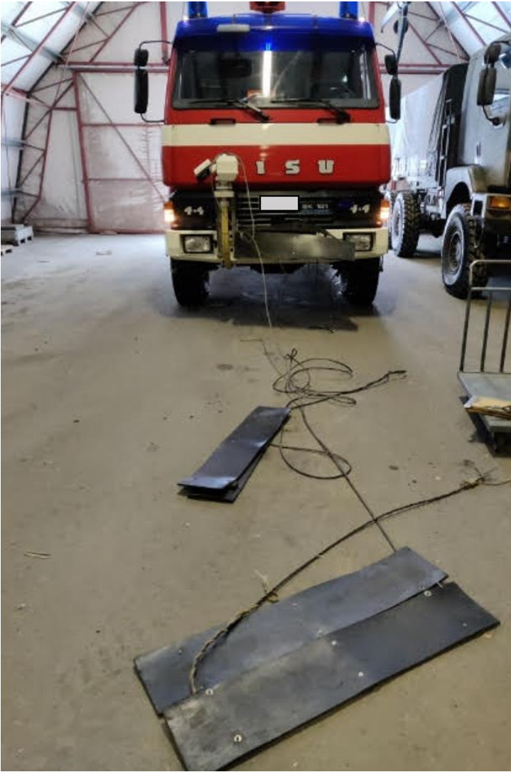
Kuvio 33. Kiinnityslenkin päästä katkennut vaijeri on singonnut kohti autoa. (Kuva: Millog Oy)
