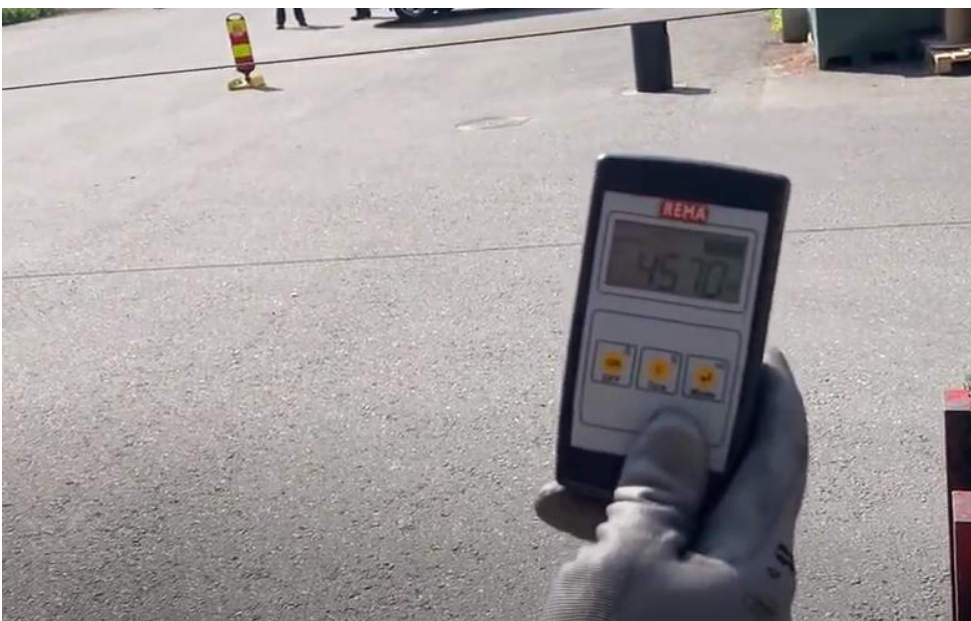
Kuvio 42. Testattava hydraulivinssin maksimi vetokyky tyhjäkäynnillä oli 4570kg.
