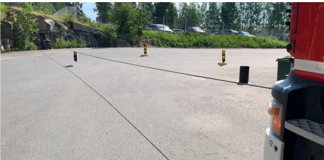
Kuvio 41. Vetotestin alkaessa vaijeri on ilmassa. Kuvassa näkyy miten turvamatto on vaijerin keskellä ja alueen eristämiseksi on laitettu varoitusmerkit.
