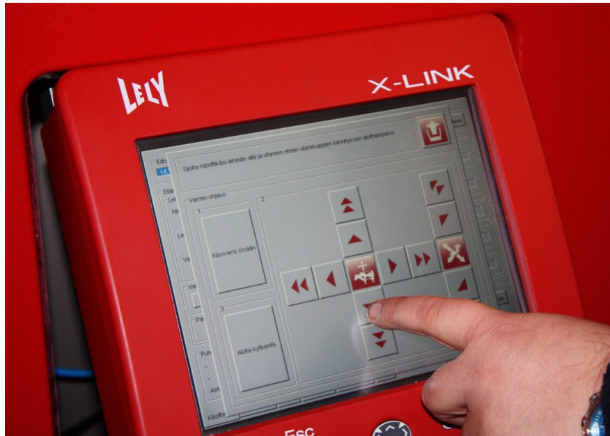
KUVA 13 Vedinkoordinaattien ensiasetuksia tehtäessä Lely Astronaut lypsyrobotin käsivarsi ohjataan manuaalisesti lehmän alle robotin kosketusnäytön avulla.
