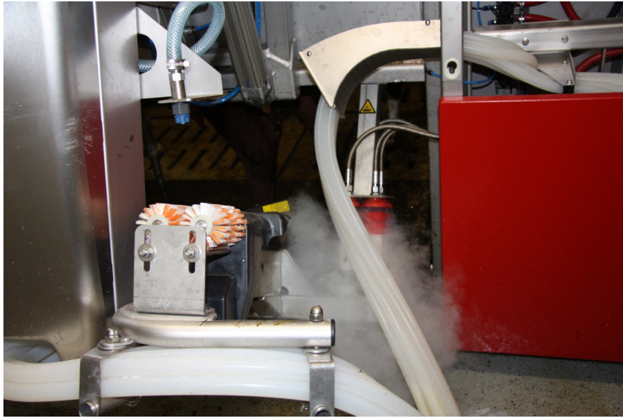
KUVA 3 Lypsinten desinfiointi kuumalla höyryllä.
