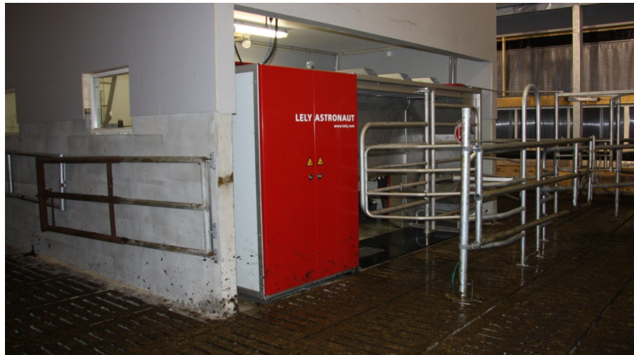
KUVA 10 Väliaikaisten porttien avulla eläin saadaan helpommin lypsy robottiin, Kuva- vassa portit on käännetty sivuun pois vapaan lehmäliikenteen tieltä.
