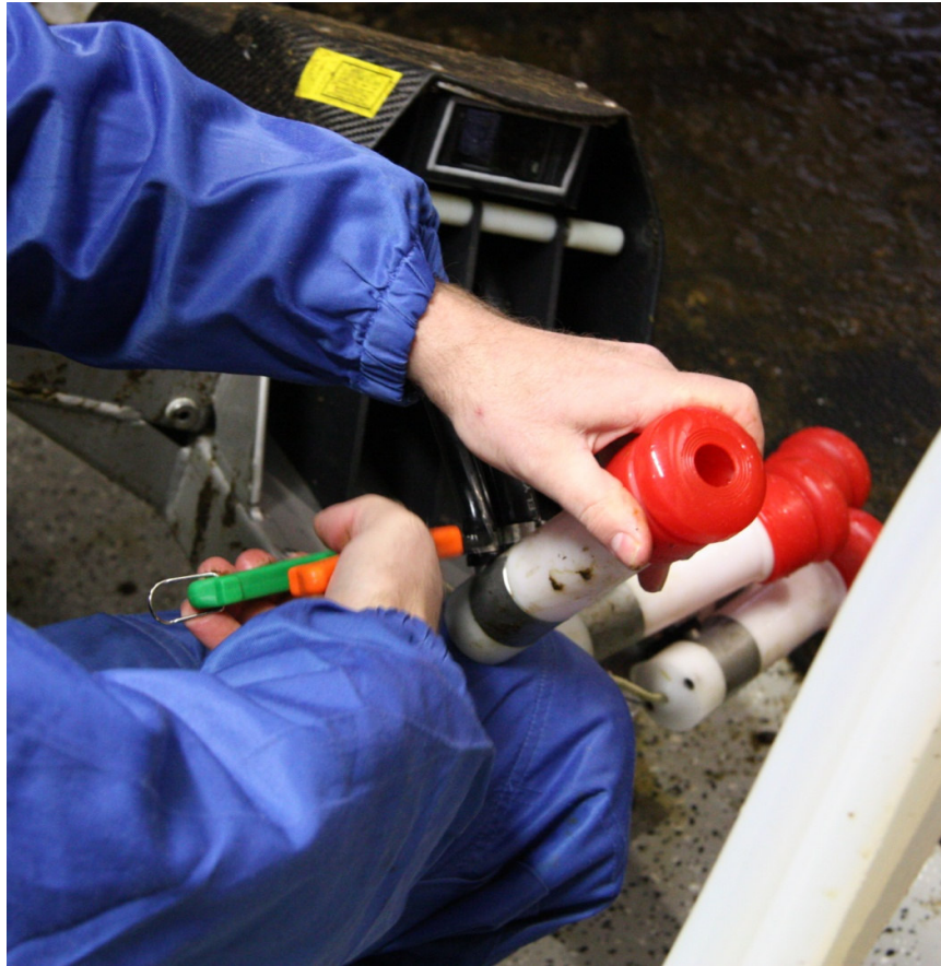
KUVA 9 Käyttöönottossa käydään läpi perushuoltotoimenpiteitä, kuten paineletkujen ja narujen lyhennys ja nännikumien vaihto.
