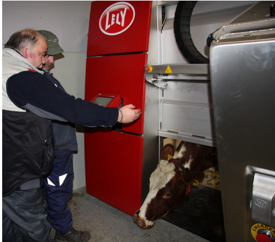
KUVA 12 Ensimmäinen lypsy. Käyttöönottossa laitetoimittajan edustaja opastaa tilan väkeä vedinkoordinaattien ensiasetusten määrittämisessä.
