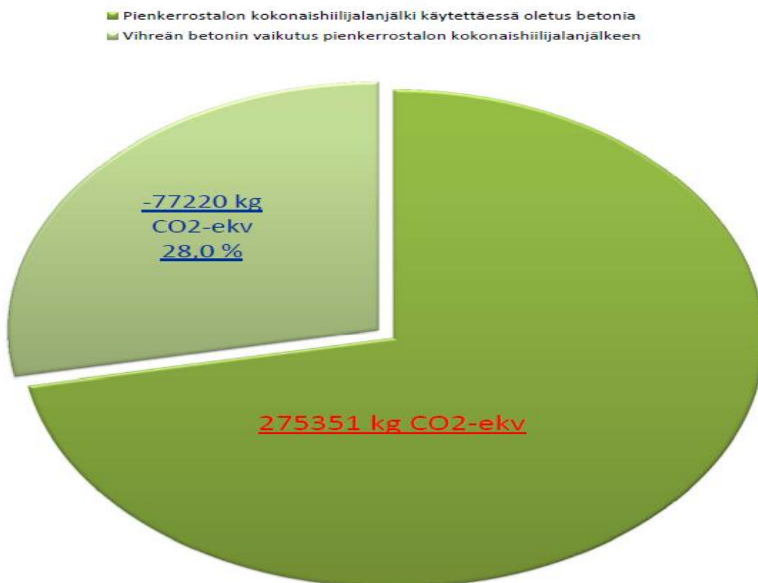
KUVA 20. Vihreän betonin käytön vaikutus pienkerrostalon kokonaishiilijalanjälkeen
