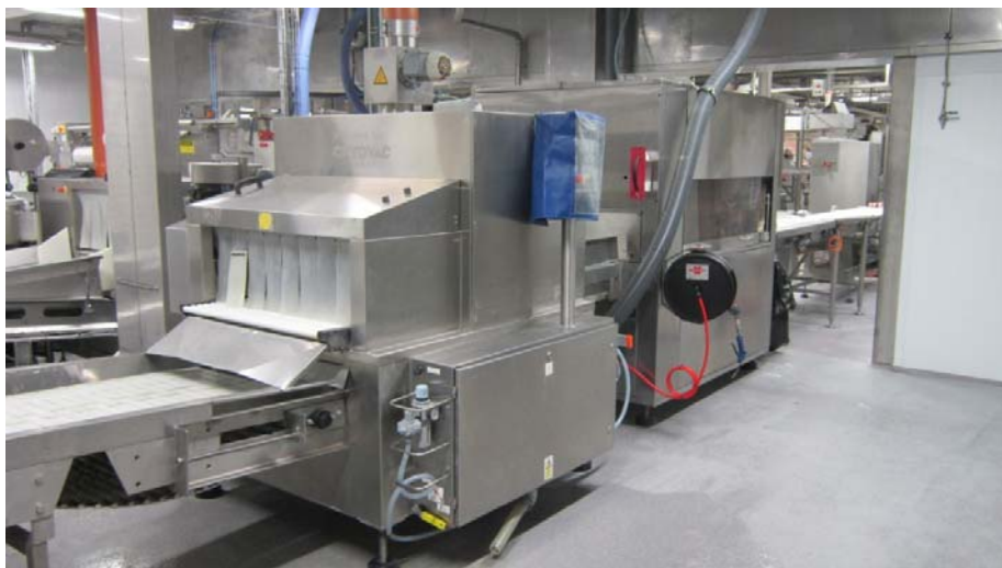
Kuvio 5. Vakuumpakkauskone ja kutistusallas.
