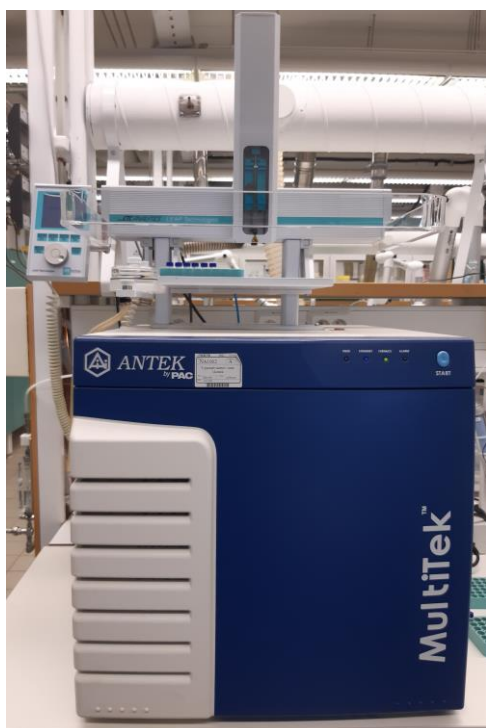
Kuva 3. Antek Multitek pystysyötön kokonaistyyppianalysaattori, jossa on automaattinen näytteensyöttäjä analysaattorin päällä.
