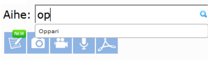
KUVA 11. Autocomplete-funktio näyttää Ajax-kutsulla palautettujen ”op” merkkeihin täsmäävät aiheet, jotka haetaan tietokannasta.
