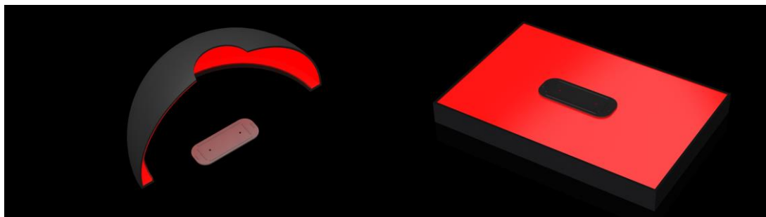
Kuva 5. a) Kohde valaistu kupolivalaisimella (poikkileikkauskuva) ja b) kohde taustavalaistimen päällä.
