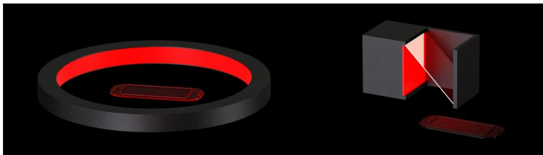
Kuva 4. a) Kohde taustavalaistuna ja b) kohde valaistuna aksiaalisella diffuusivalolla (poikkileikkauskuva).
