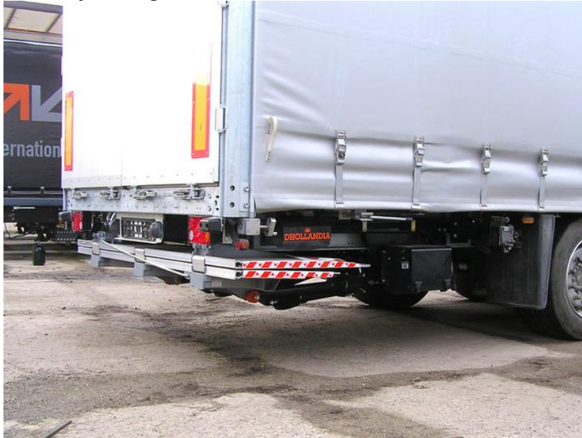
Kuva 4. Flowertrucks Oy:n käyttämä vastaavanlainen Dhollandia alleajettava perälautanostin
